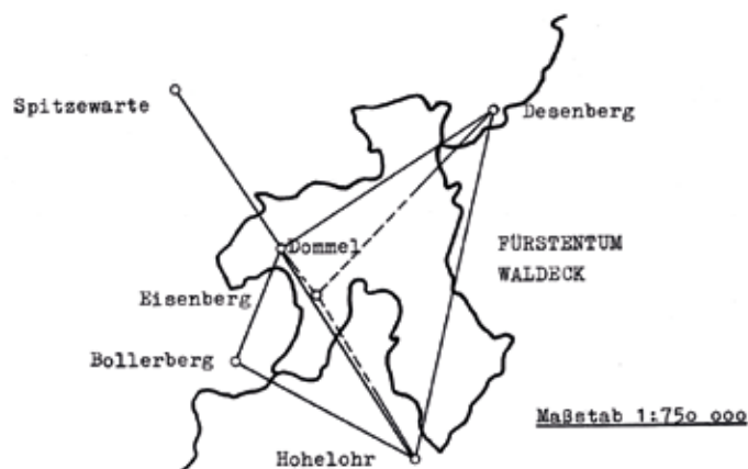
Abb. 10: Verbindung der Waldeckischen Triangulation mit der Triangulation I.O. im Regierungsbezirk Minden durch Vorlaender (siehe dazu [5] Schmidt 1960, Nr. 124 – 128)
