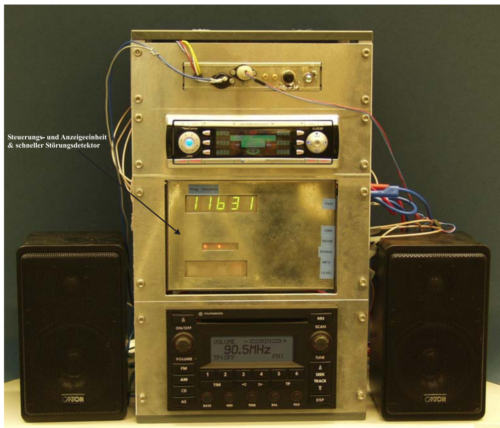
Abbildung 4.17: Multidetektorsystem im Testbetrieb mit zwei Rundfunkempfängern
