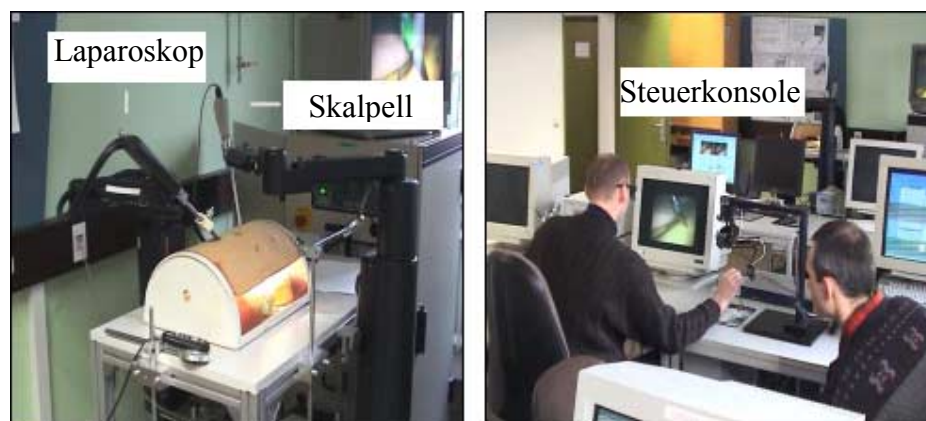
Abb. 24: Sensorisches Experiment: Bei der Teleoperation wurden zwei Roboterarme, die mit einem Stereolaparoskop und einem Skalpell ausgestattet waren, in eine Patientenbox eingeführt (links). Der Operateur kommandierte den Eingriff an einer räumlich getrennten Steuerkonsole (rechts).
