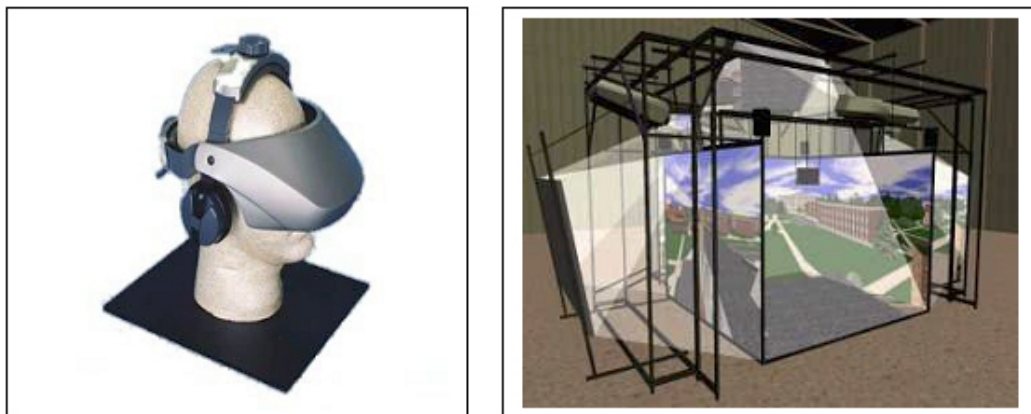
Abb. 8: Optische Ausgabegeräte: Links: Head-Mounted-Display (Quelle: Fifth Dimension Technologies Inc.) – Rechts: CAVE (Quelle: Fakespace Systems Inc.).
