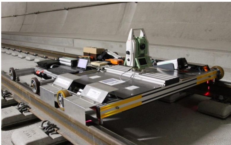
Abb. 5: Gleismesssystem RACER II (Strübing 2015)
