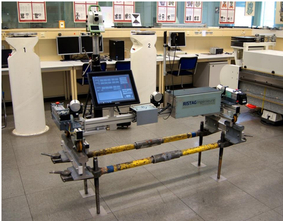
Abb. 4: Gleismesssystem GML auf Stützvorrichtung im Geodätischen Labor der Universität der Bundeswehr München
