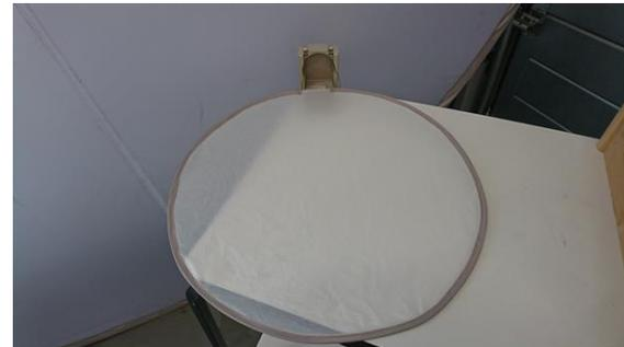
Fig. 10 Das Dragsail-Subsystem mit einem entfaltenen Segel
