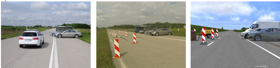
Abbildung 5: Querverkehrsszenario mit freiem (links), belegtem Gegenfahrstreifen (Mitte) und im VIL (rechts)
