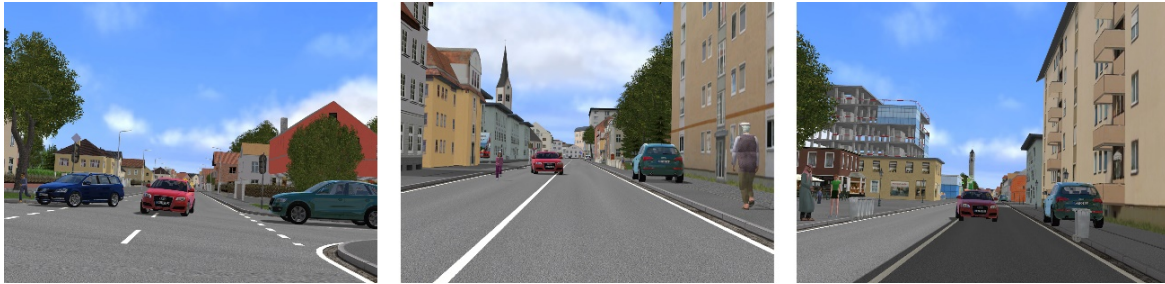
Abbildung 3: Testfall 1 – Fahrsituationen „Abbieger“(links), „Kind“(Mitte) und „Falschauslösung“(rechts)
