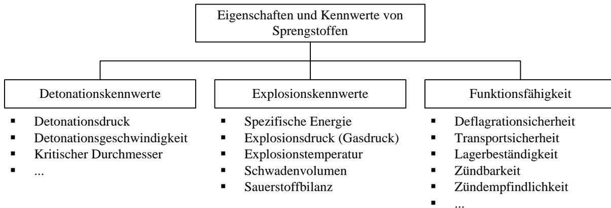
Abbildung 4.2 Eigenschaften und Kennwerte von Explosivstoffen nach DIN 20163 [91]
