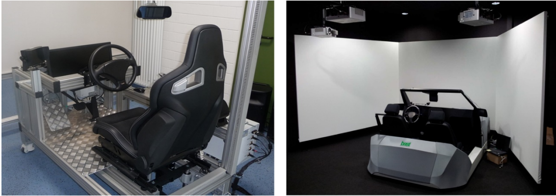
Abbildung 14: Sitzkiste der TU Kaiserslautern (Lehrstuhl für Mechatronik in Maschinenbau und Fahrzeugtechnik 2011) und statischer Fahrsimulator der BAST (Frey 2014, S. 38)
