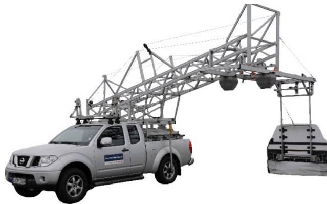
Abbildung 12: Seitenausleger-Crashmatic von Bosch
