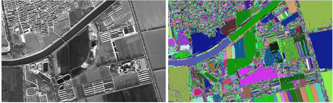
Abbildung 2.1: Segmentation einer panchromatischen World View 1 Szene, links die Satellitenbildaufnahme, rechts die Labelmaske
