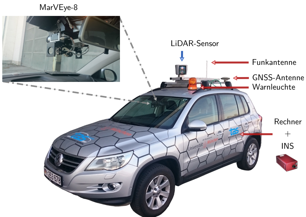
Abbildung 6.3: MuCAR-4: Umgebauter VW Tiguan und dessen Sensorausstattung.
