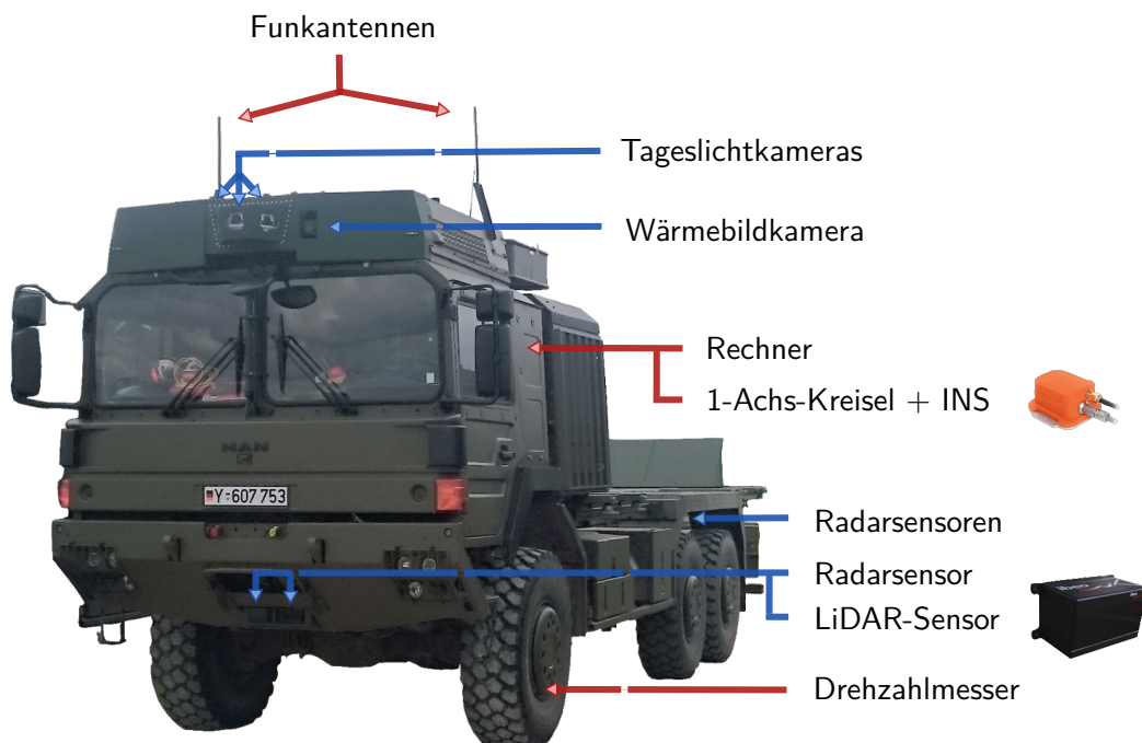
Abbildung 6.5: StrAsRob: Sensorausstattung eines umgebauten Lkw vom Typ RMMV HX58.
