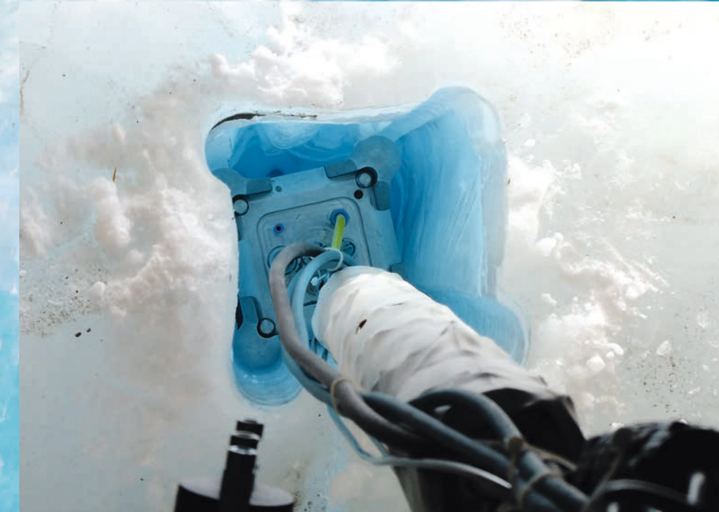
Die EnEx- Sonde gräbt sich in das arktische Eis (Quelle DLR)
