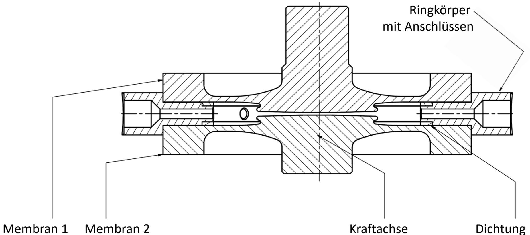
Quelle: Ittner, R. et al.: Entwicklung einer Druckdose zum hochfrequenten Test von Verbindungen in der Hydraulik bis 600 bar. Projektarbeit im Fach Experimentaltechnik. Universität der Bundeswehr München: 2017
