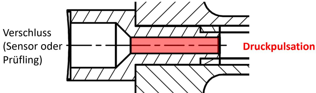
Druckverlust in **Engstelle** bei 100 Hz Prüffrequenz
