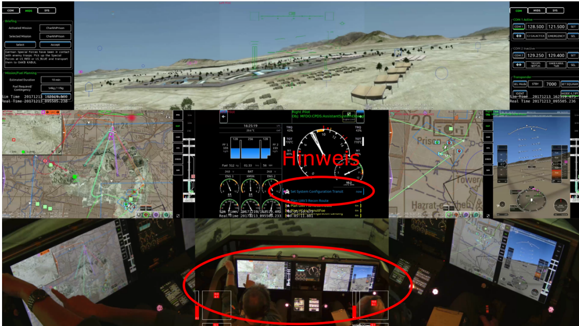
Abbildung 7.8: Assistenzsystemeingriff: Automatisches Setzen der Systemkonfiguration für den Transitflug während einer Beanspruchungsspitze.
