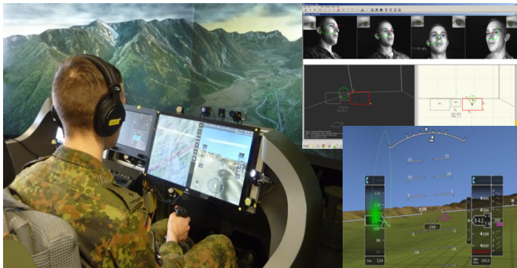
Abbildung 6.13: Automatische Beobachtung der Mission während der Durchführung der Experimente. Hier: Blickbewegungsmessung. Vgl. (Mehler, 2014).
