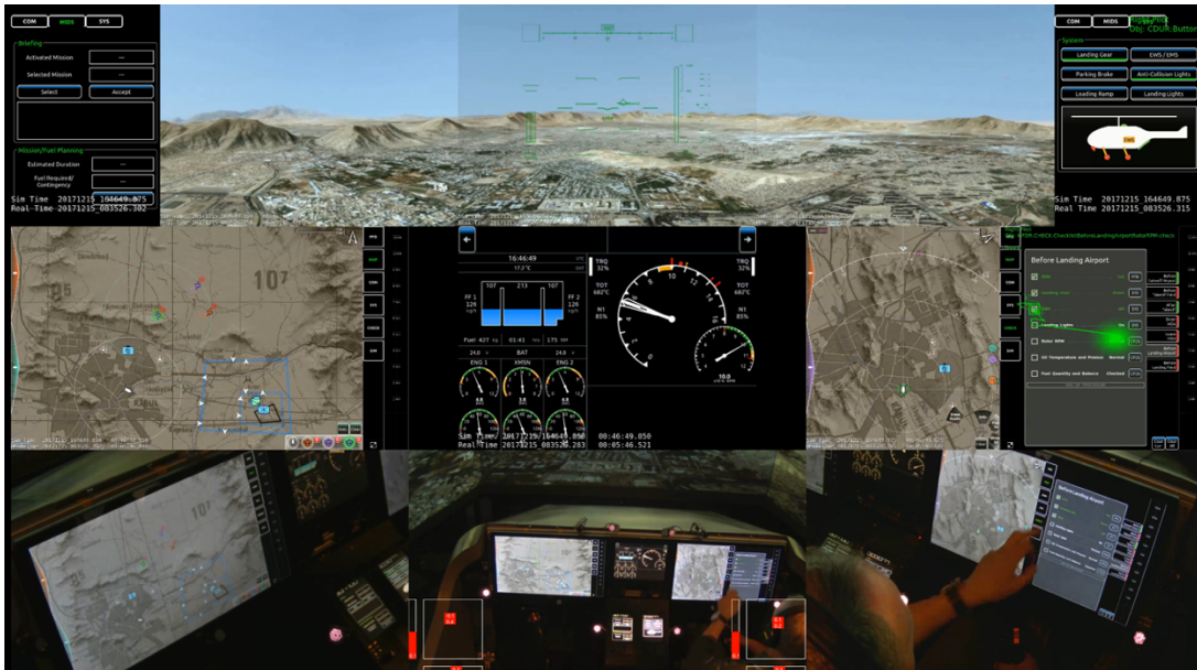
Abbildung 6.25: Fallbeispiel 1: Abarbeiten der Landecheckliste durch den rechts sitzenden fliegenden Piloten.
