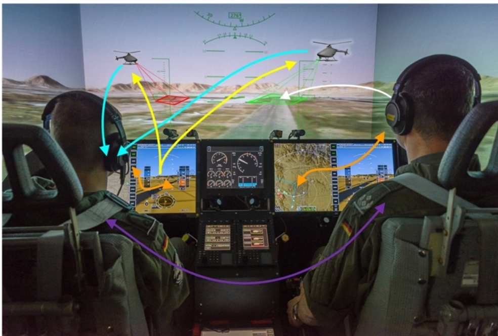
Abbildung 5.2: Schematische Darstellung des MUM-T Hubschraubersimulators des Instituts für Flugsysteme an der Universität der Bundeswehr in München. Aus (Ruf u. a., 2017).
