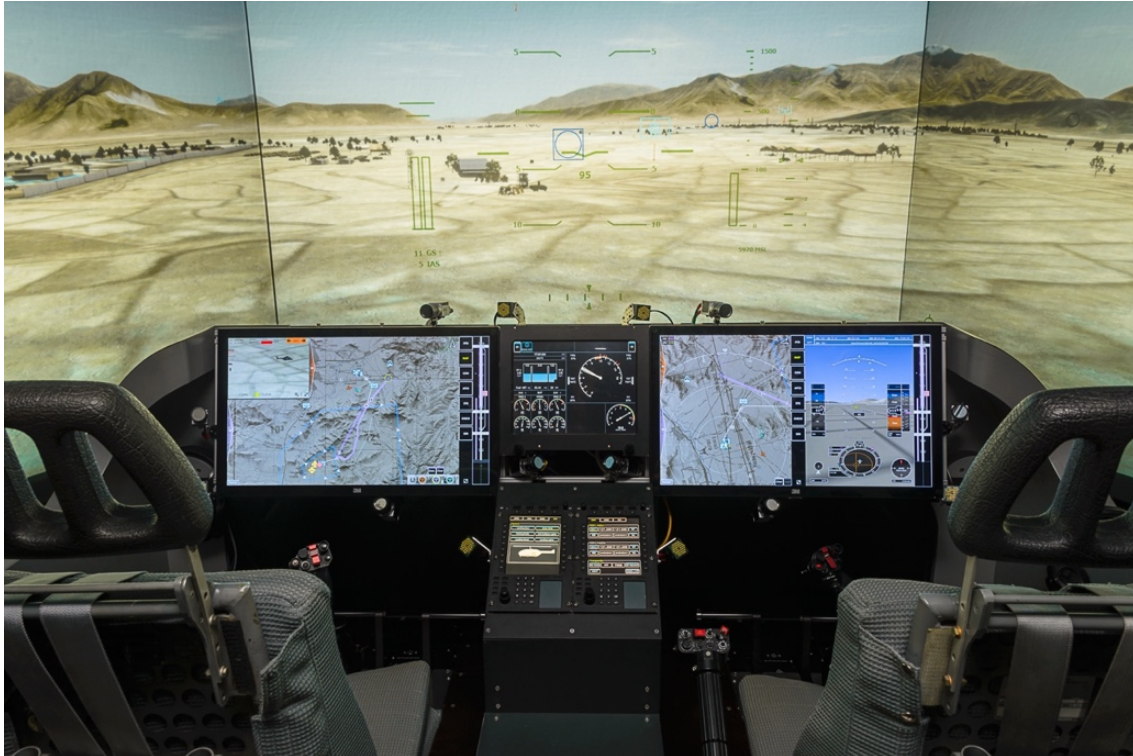
Abbildung 5.5: Hubschrauber-Missionssimulator am Institut für Flugsysteme. Foto aus (Weinmann u. a., 2016).
