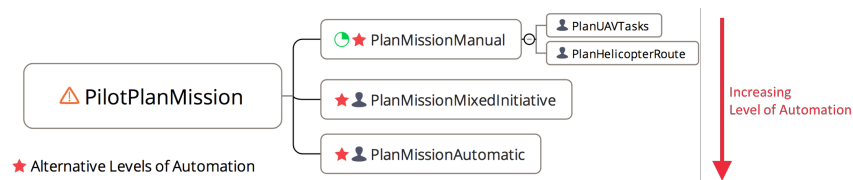
Abbildung 3.8: Beispiel für die Einbeziehung verschiedener Automationsgrade im Aufgabenmodell. Grafik aus (Honecker u. a., 2016).
