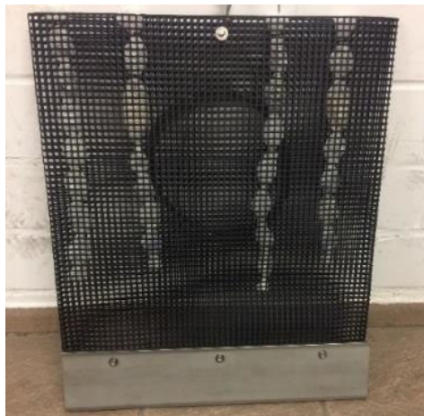
Abbildung 20: Probenaufbau zur Exposition der ausgewählten Kunststoffe in einzelne Stufen des Klärprozesses. Die Kunststoffe sind in Gewebesläuchen gesichert und in einem Gestell zur Fixierung an der gewünschten Stelle befestigt (Abschlussbericht der Technischen Universität Darmstadt, 2021)
