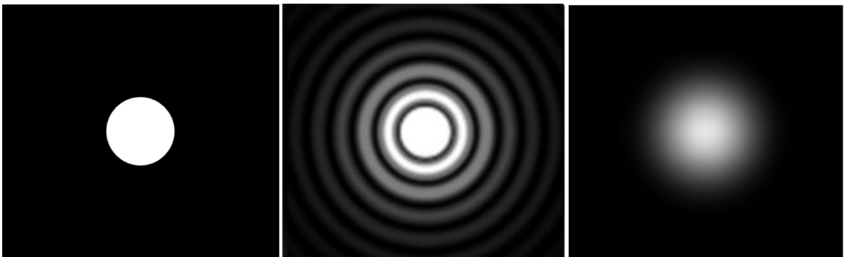
Abbildung 22: Schematische Abbildung der Entwicklung einer punktförmigen Lichtquelle über die Abbildung durch ein optisches System und die Rekonstruktion des Originalbildes durch Entfaltung (von links nach rechts).
