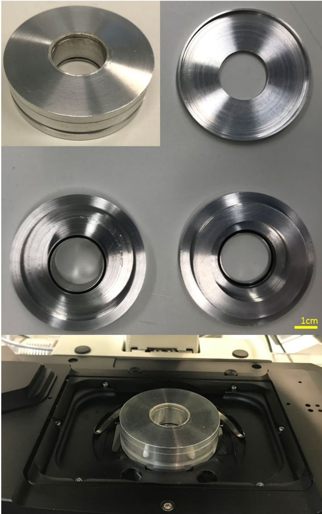
Abbildung 37: Abbildung der im Laufe dieser Arbeit entwickelten LCI-Kammer zur Lebendzellmikroskopie von Zellen auf Deckgläsern. Die Kammer besteht aus drei Teilen (oben rechts, mitte) und kann durch einen Schraubmechanismus zusammgebaut werden. Nach Einsetzen des Deckglases und Befüllung mit Medium kann die LCI-Kammer in den Z-Galvo-Feinfahrmechanismus des Leica-Mikroskops eingebaut werden (unten).
