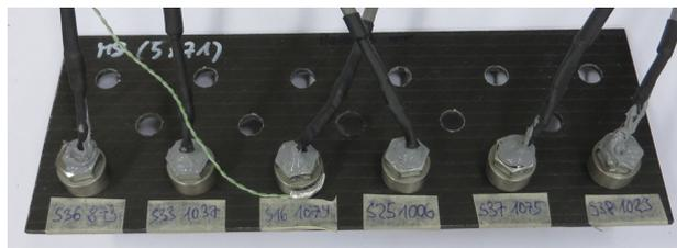
Abbildung 4.2: Prinzipieller Prüfaufbau zur Messung des Vorspannkraftverlustes
