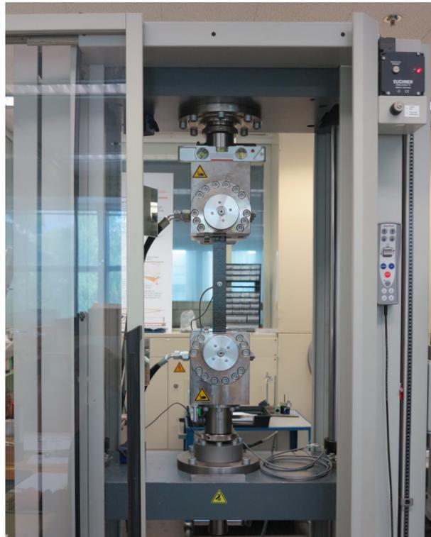
Abbildung 5.17: Zugprüfmaschine zur Untersuchung der reibschlüssigen Lastübertragung doppelschnittiger M8 Schraubenverbindungen unter statischer Belastung
