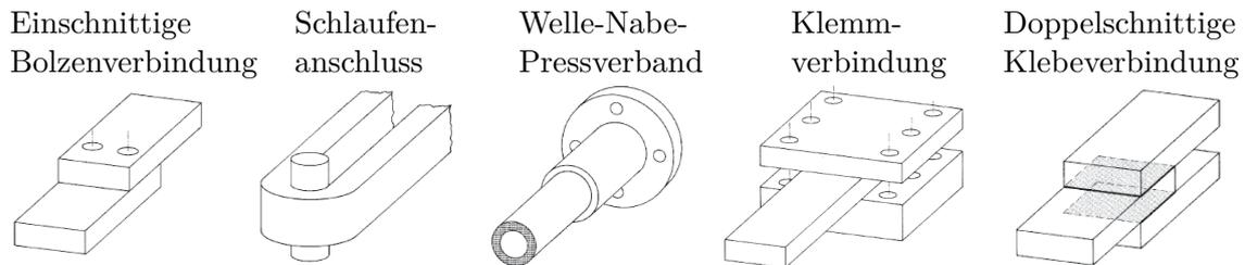
Abbildung 2.2: Ausgewählte Verbindungstechniken für Faserverbundwerkstoffe (nach Schürmann [3])
