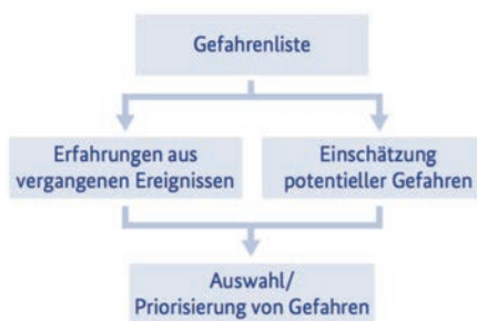
Abbildung 6-4: Ablaufschema einer Gefahrenanalyse (Wienand und Hasch, 2019)
