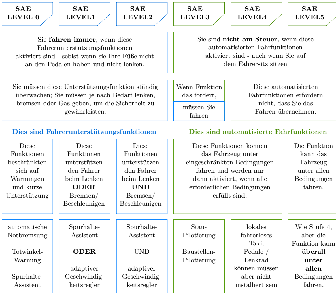
Abbildung 2.1.: Stufen der Automatisierung von Fahrzeugen der SAE International [98]
