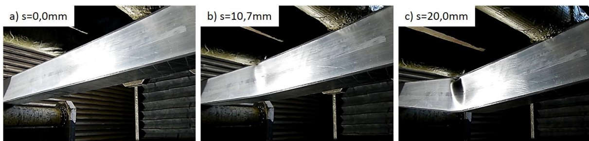
Abbildung 4-6: Versagensbild SHS4. a) Versuchsbeginn b) Bruch CFK und Beginn Stegbeulen c) Ausgeprägtes Einknicken des Profils nach dem ersten Versagen.
