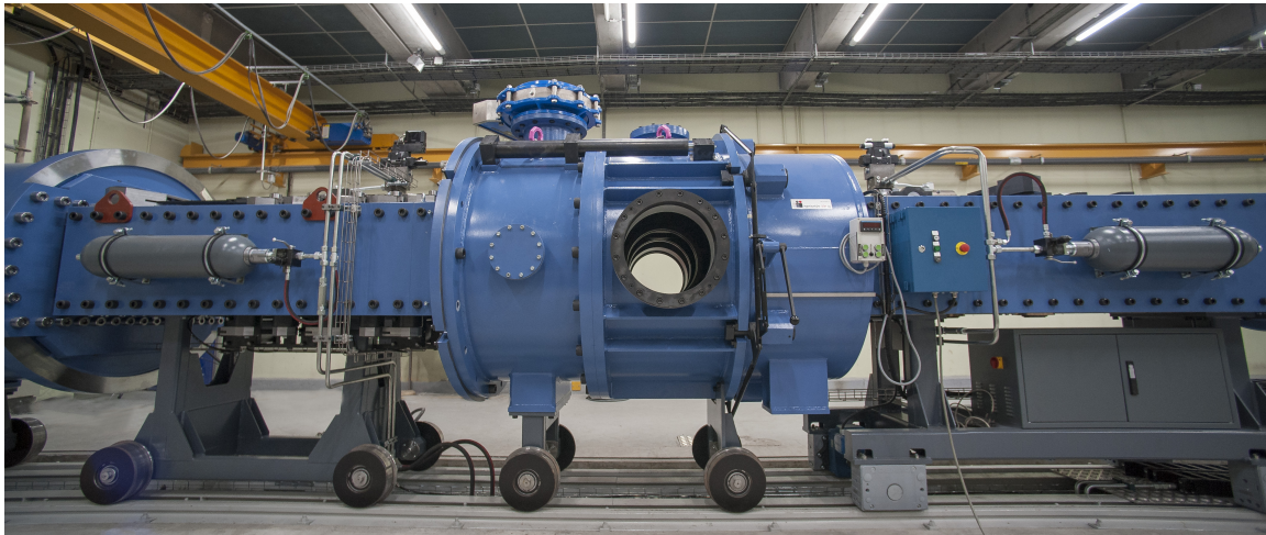
Abbildung 2.1: Trisonischer Windkanal mit eingebauter transsonischer Teststrecke
