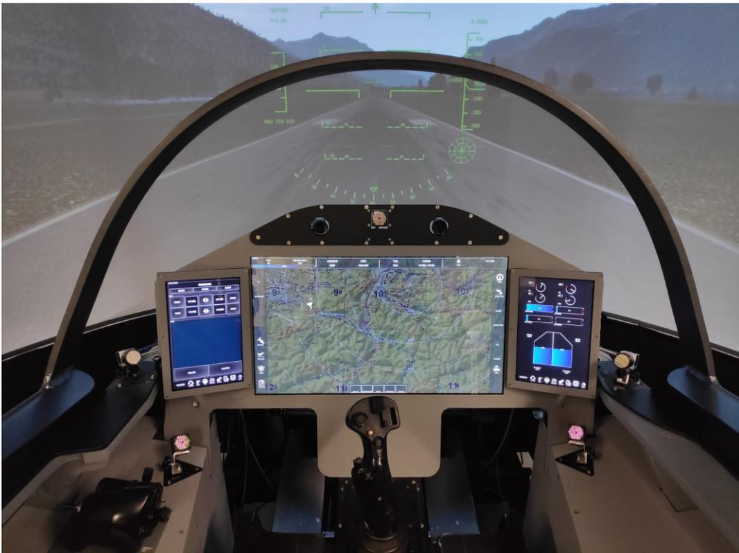
Abbildung 4-1 - Der Cockpitsimulator am IFS besteht aus einem Sichtsystem mit HUD, drei Touchscreens sowie einem HOTAS System und Ruderpedalen zur Bedienung.
