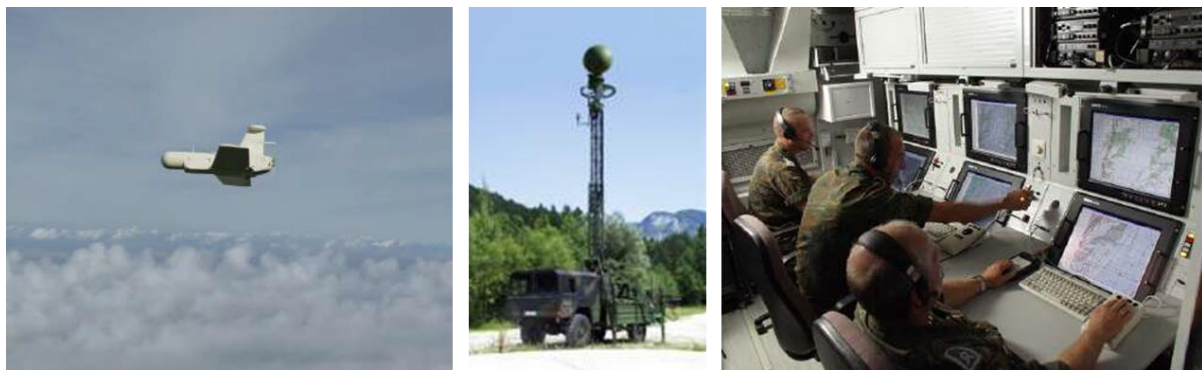
Abb. 5: Systemkomponenten eines UAS am Beispiel der KZO nach [WoBl07]: Fluggerät KZO UAV (links), Datenlink (mittig), Bodenkontrollstation (rechts) mit Flugführungs-, Sensor- und Kommunikationsarbeitsplatz.
