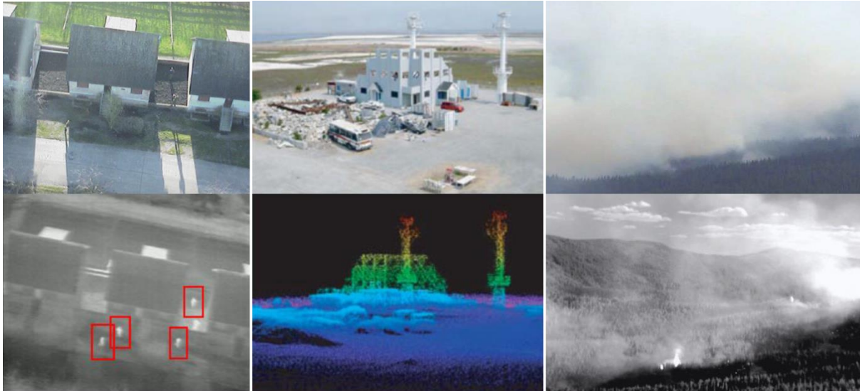
Abb. 1: Vorteile durch Wechsel des Sensorprinzips je nach Aufgabe und Umweltkonstellation: Personenerkennung mittels Infrarotsensor (links unten, [GaBH11]), Hinderniserkennung mittels LIDAR (mittig unten, [Kend12]) sowie zur Brandherdlokalisierung im SWIR-Sensorbild ( Short-Wave Infrared , rechts unten, [Dawe09]).
