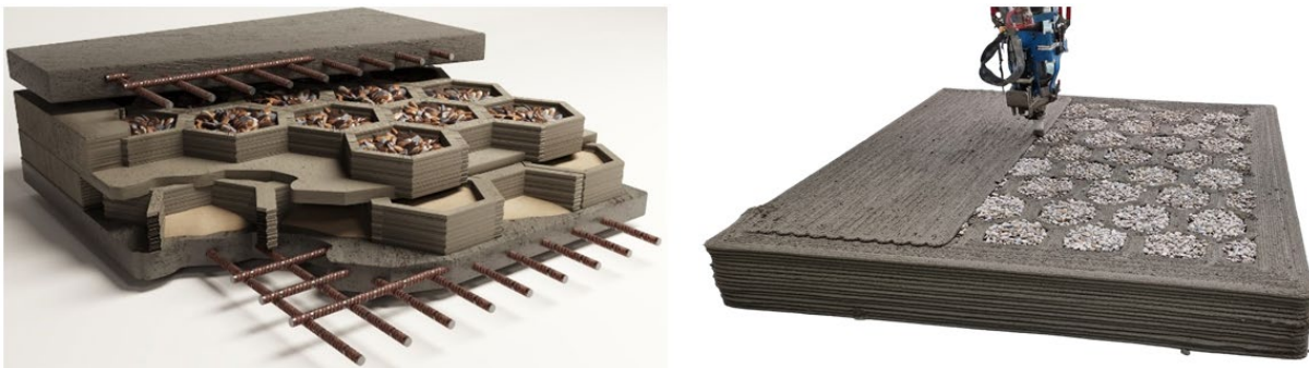
Abbildung 1- 3D-gedruckte mehrschichtige Platte mit innerer Wabenstruktur
