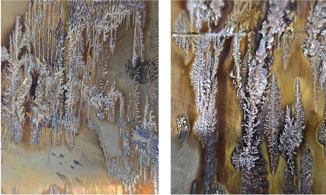
Bild 12.4 Beispielhafte Darstellungen der Schäden entsprechend dem Schadensbild der Klasse 1 und der Ausprägung 2
