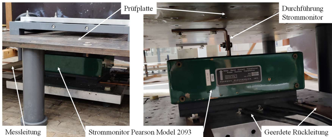
Bild C.3 Strommonitor vom Typ Pearson Model 2093 unterhalb der Prüfplatte
