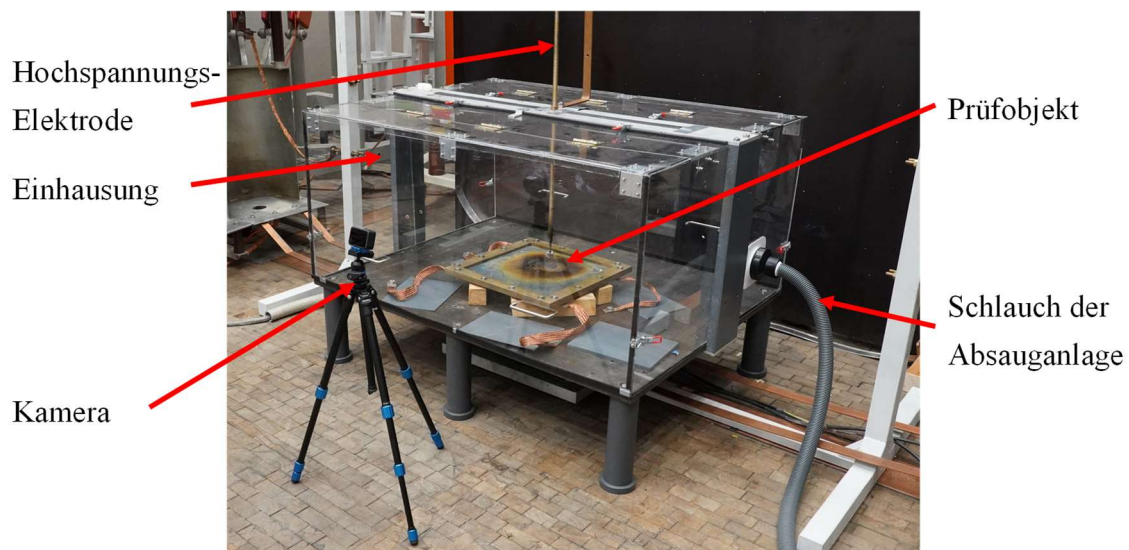
Bild 10.7 Prüffeld mit PVC-Einhausung
