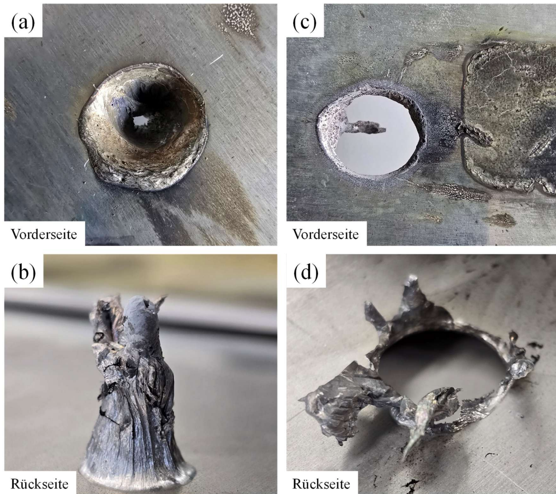
Bild 12.8 Zwei Beispiele für das Schadensbild der Klasse 3 mit (a, c) Lochbildung auf der Vorderseite und (b, d) abgetropftem Aluminium auf der Rückseite der Aluminium-Platte
