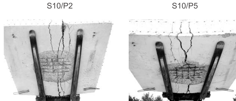
Bild 7.9: Vorschädigung der Platten S10/P2 und S10/P5 durch Sprengbeanspruchung
