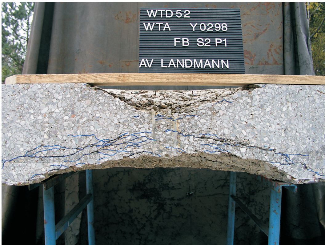
Abbildung 8.17: Schnittbild einer angesprengten Stahlfaserbetonplatte
