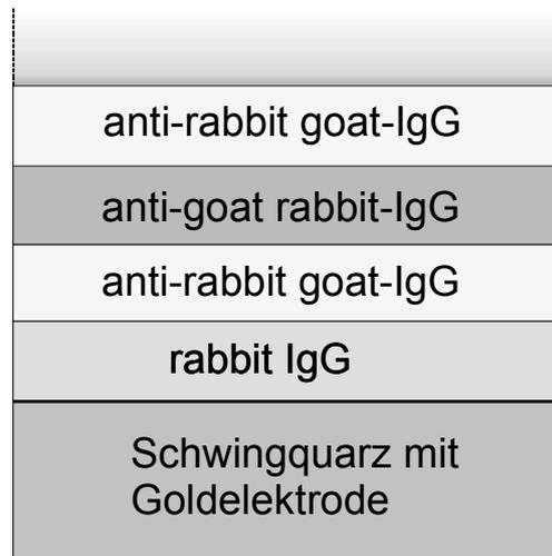
Abbildung 7.7: Multilayer-Antikörperschichten auf Schwingquarzsensoren.
