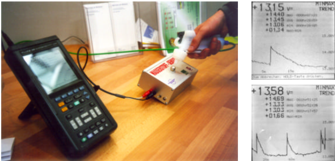
Abb. 6.20: Demonstratoraufbau des Sensors für Messeauftritte und Vorführungen. Rechts: Screenshots nach einer Begasung
