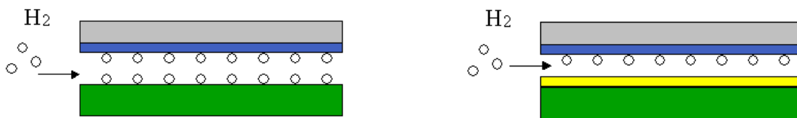
Abb. 2.3: Links: Relativmessung ohne Feldänderung und ohne resultierendes Messsignal. Rechts: Relativmessung mit innerer Passivierungsschicht und vollem Messsignal
