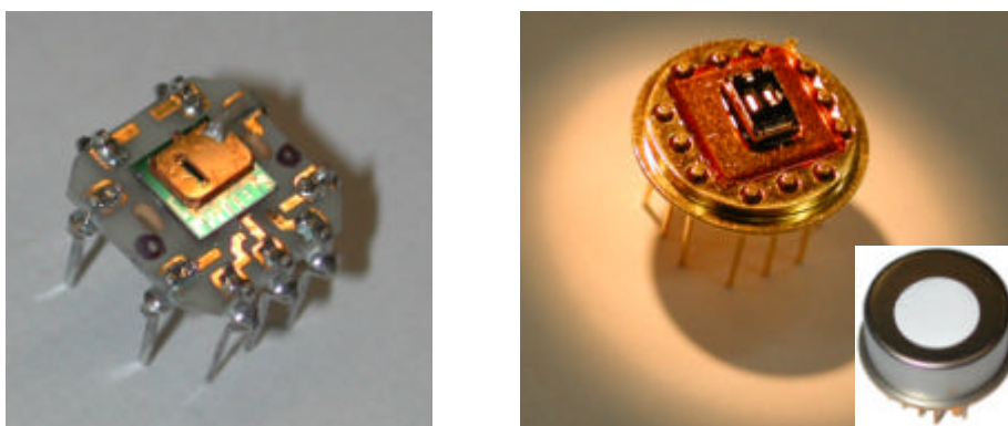
Abb. 4.14: Fotos von aufgebauten Prototypen: links Ozonsensor mit Sockel-Eigenbau, rechts Wasserstoffsensoren mit Doppelsensoren auf T0-8 Sockel mit zusätzlichem Isolierplättchen und unten mit Filterkappe
