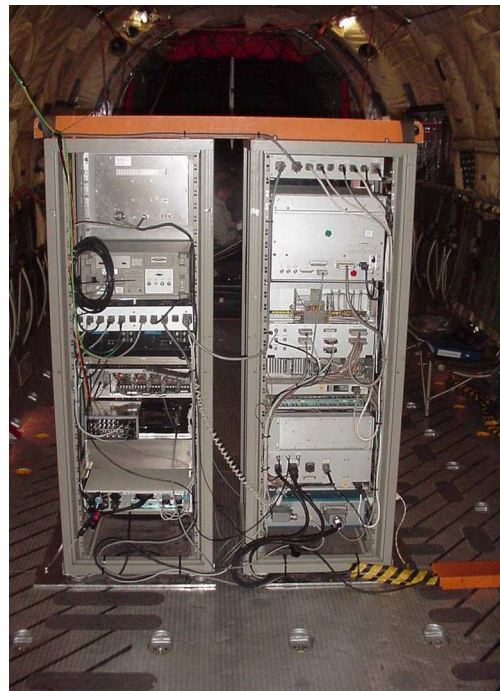
Abb. A.10: Steuerungs- und Aufzeichnungseinheit von MEMPHIS an Bord der Transall.
