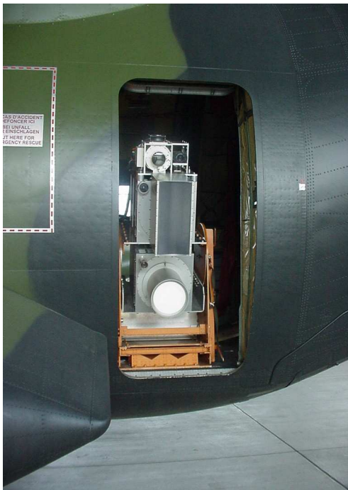
Abb. A.9: Seitlich aus der Transall herausblickender Antennenaufbau des SAR-Systems MEMPHIS.
