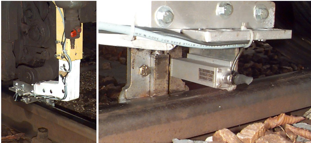
Abbildung 4.7: Die Abbildung zeigt links den linken Messarm der Plattform, der am unteren Ende die beiden Ultraschallsensoren zur Messung der vertikalen und horizontalen Entfernung zum Gleiskopf aufnimmt. Rechts eine Vergrößerung des rechten Messkopfes.
