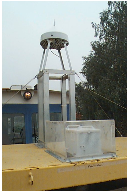
Abbildung 4.5: Strapdown INS Sigma30 mit GPS Choking Antenne
