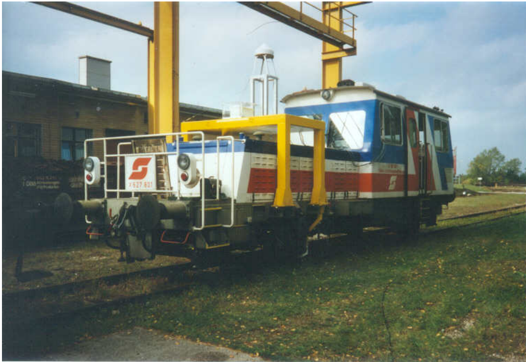
Abbildung 4.2: Messfahrzeug der Österreichischen Bundesbahn (ÖBB) mit aufgesetzter Messplattform
