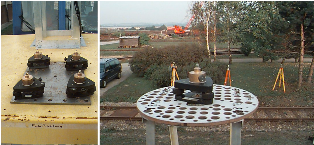
Abbildung 4.9: Zur Vermessung der Plattform wurden Zielmarken am Aufnahme- punkt der GPS-Antenne (rechts) sowie auf den Montagepunkten des INS (links) angebracht.
