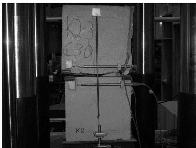
Bild D.2: Rissbilder der Versuche K2-1-C30 bis K2-3-C30
