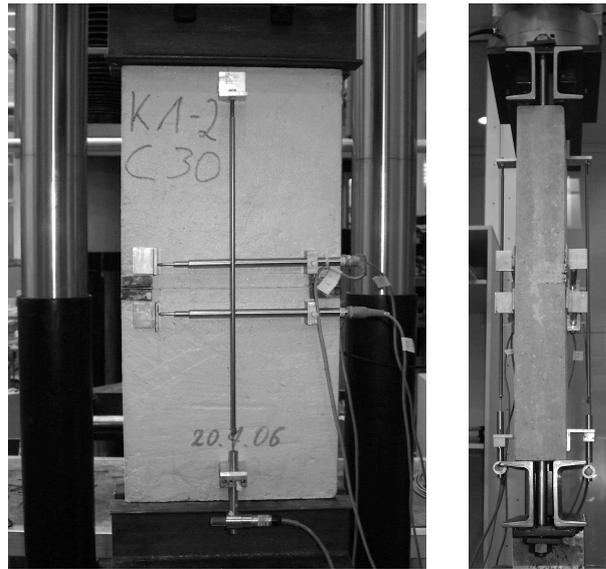
**Bild C.6:** Versuchsserie PA mit Belastungsvorrichtung
