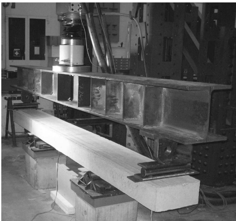
**Bild 6.13:** Ansicht des Aufbaus der Versuche mit Plattenstreifen [63] (Anhang C.3)
