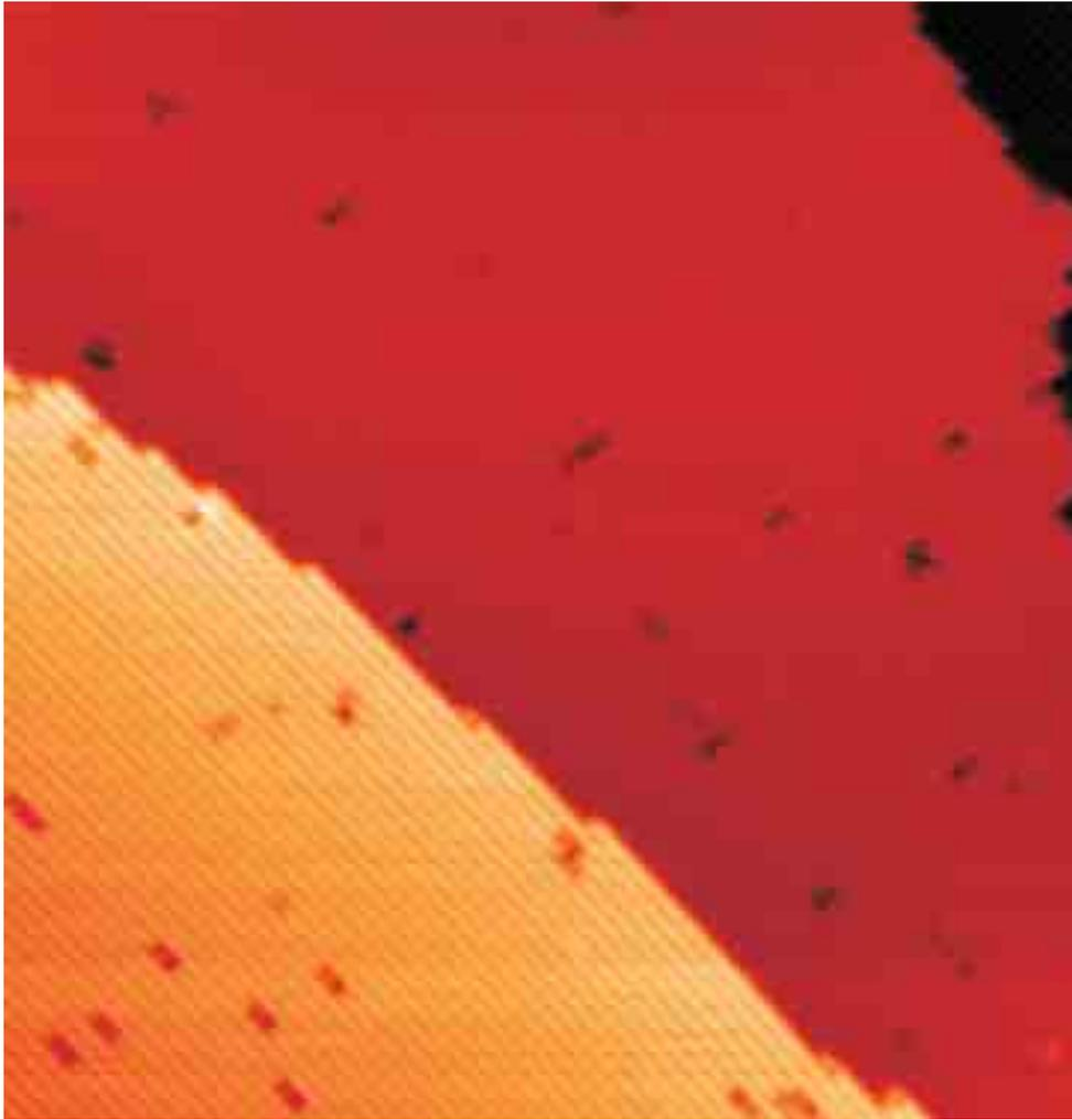
**Abbildung 4.6:** STM-Bild einer perfekt präparierten Siliziumoberfläche eines Si(100)-Substrats, die in der Si(100)- $2 \times 1$ -Rekonstruktion vorliegt. Die Terrassen mit den monoatomaren Terrassenstufen sind deutlich erkennbar. Die farblich abweichenden Punkte in den Terrassenebenen weisen auf fehlende Si-Atome in der entsprechenden Ebene hin.
