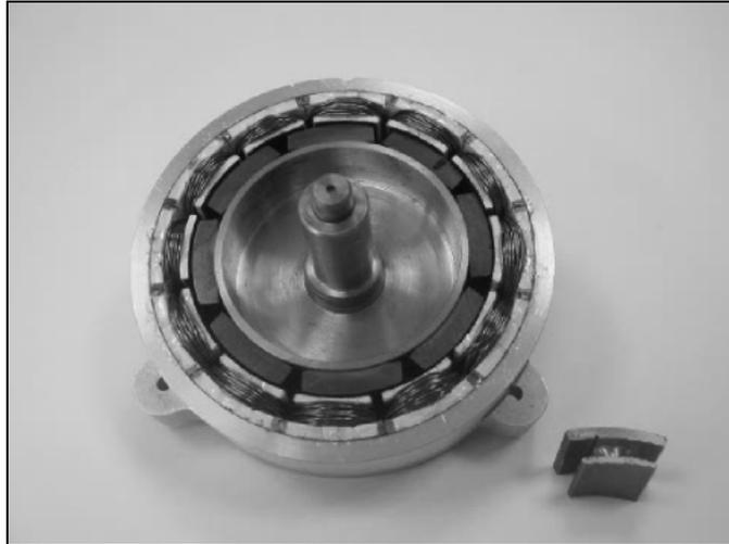
Abb. 3-3 Bürstenloser Gleichstrommotor mit einem segmentierten Stator aus weichmagnetischem Pulververbundwerkstoff und Einzelzahnwicklung. Unten rechts im Bild findet sich ein einzelnes Statorsegment.
