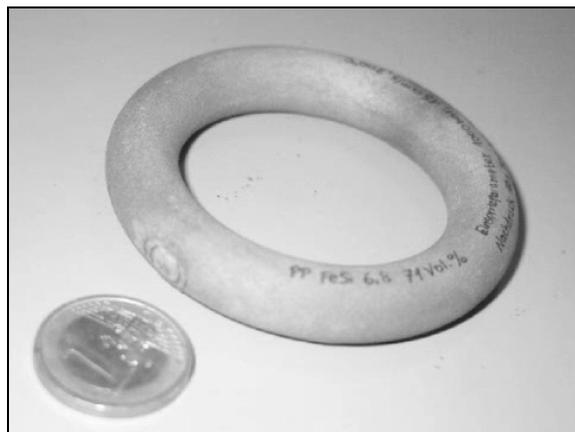
Abb. 8-6 Darstellung eines hochgefüllten, kunststoffgespritzten Toroiden mit einem Anteil des weichmagnetischen Materials am Bauteilvolumen von 70Vol.-%.
