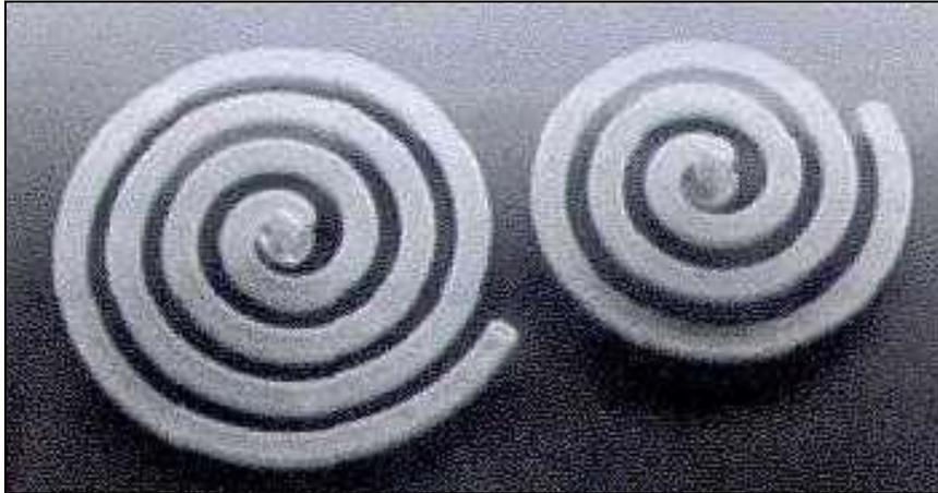
Abb. 6-3 Spiraltest zur Bestimmung des Fließverhaltens bzw. der Viskosität. Bei der linken Spirale wurde ein Gleitmittel zur Verringerung der Viskosität verwendet, was sich durch einen längeren Fließweg äußert. Bei der rechten Spirale zeigt sich aufgrund fehlender Additive ein geringerer Fließweg [Rich-02].
