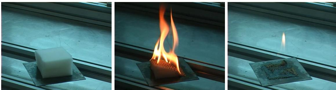
**Abb. 5.24:** Ablauf des offenen Kunststoffbrandes. Polyurethan vor der Zündung, nach 30 Sekunden, nach einer Minute.
