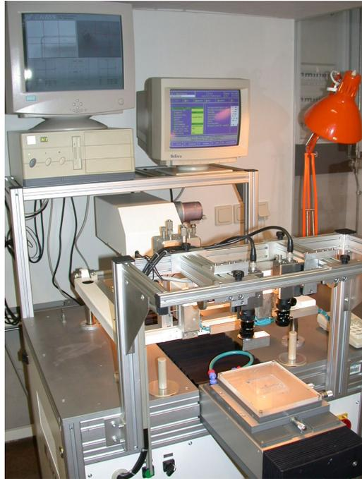
*Abb. 4.9: Aufnahme der Siebdruckmaschine M-II PC der Firma EKRA.*
