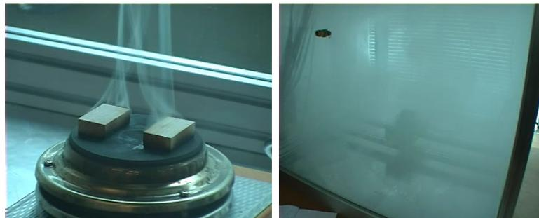
**Abb. 5.26:** Brandverlauf des Pyrolyseschwelbrandes. Pyrolyse mit Rauchentwicklung nach drei Minuten und vollständig verrauchter Kammer nach sieben Minuten.
