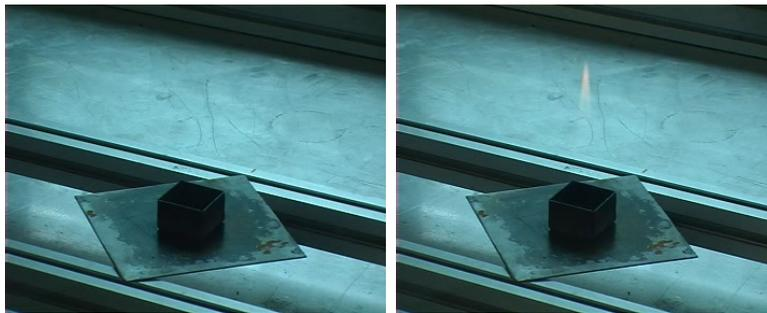
**Abb. 5.32:** Brandverlauf des offenen Flüssigkeitsbrandes (Ethanol). a) Versuchsaufbau. b) Vollentwickelter Brand mit schwacher, blasser Flamme zehn Minuten nach dem Brandbeginn.
