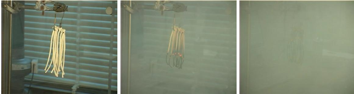
**Abb. 5.28:** Brandverlauf des Glimmschwelbrandes. a) Baumwollfäden. b) Pyrolyse mit Rauchentwicklung nach fünf Minuten. c) Stark verrauchte Kammer nach zehn Minuten.
