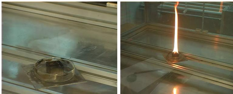
Abb. 5.30: Brandverlauf des offenen Flüssigkeitsbrandes (n-Heptan). a) Versuchsaufbau. b) Vollentwickelter Brand sechs Minuten nach der Zündung.
