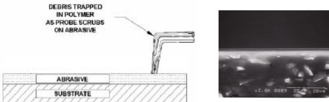
Abb. 2.6: Schematische Darstellung und REM-Aufnahme eines typ. Reinigungssubstrats im Querschnitt
