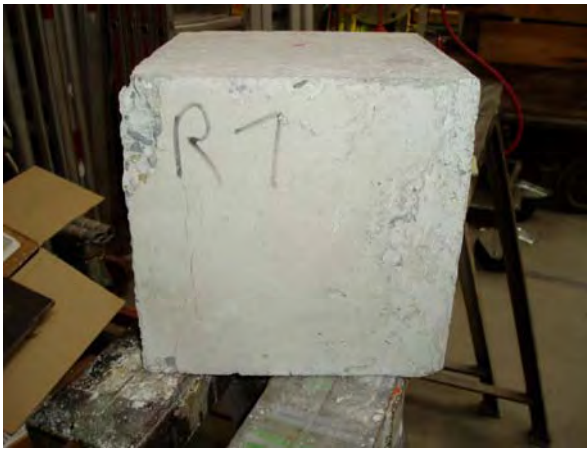
Abb. C.3.8: Referenzkörper R-1 (links) und instand gesetzter Würfel EP-0-1 (rechts) nach einaxialem Druckversuch (klassisches Würfelversagen: Ausbildung einer „Sanduhr“)
