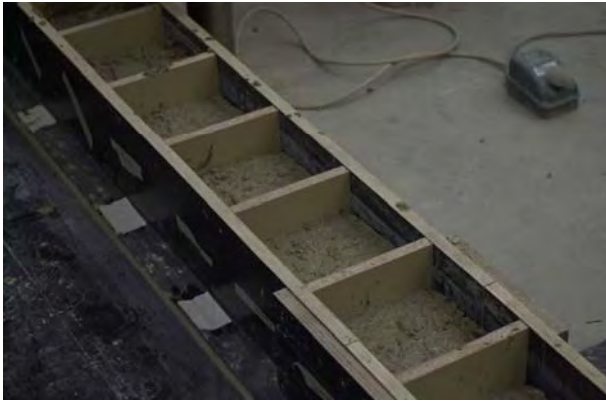
Abb. C.3.3: Schalung der Probewürfel (links) und eingelegter Draht gegen Auseinanderfallen des Würfels nach Vorschädigung (rechts)
