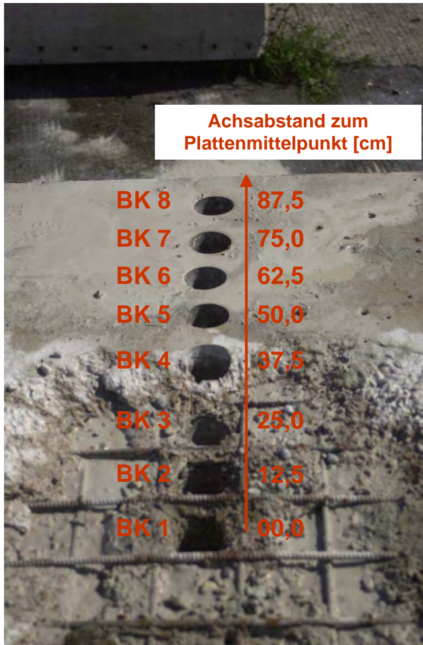
Abb. B.1.3: Bohrraster Platte WTD 2
