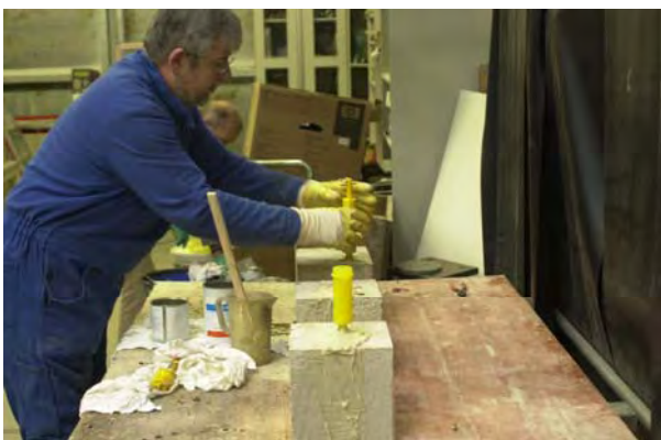
Abb. C.3.5: Instandsetzen der Probekörper durch Verpressen mit Epoxidharz mittels Niederdruckinjektion mit Selbstinjektor
