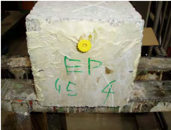
Abb. C.3.9: Instand gesetzte Würfel EP-45-4 (links) und EP-90-1 (rechts) nach einaxialem Druckversuch (klassisches Würfelversagen: Ausbildung einer „Sanduhr“)
