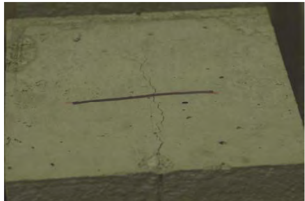
Abb. C.3.4: Riss infolge Spaltzugbelastung als Vorschädigung
