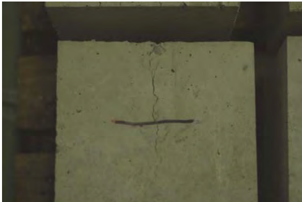
Abb. C.3.4: Riss infolge Spaltzugbelastung als Vorschädigung
