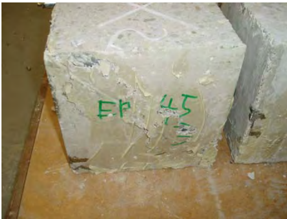
Abb. C.3.10: Instand gesetzter Würfel EP-45-3 nach einaxialem Druckversuch (Versagen: entlang der Verpressfuge)
