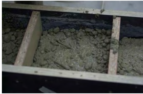
Abb. C.3.3: Schalung der Probewürfel (links) und eingelegter Draht gegen Auseinanderfallen des Würfels nach Vorschädigung (rechts)
