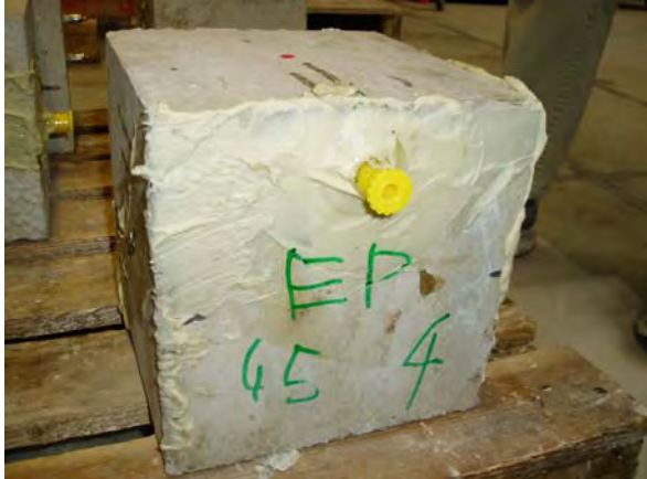
Abb. C.3.7: Instand gesetzte Probekörper vor einaxialem Druckversuch (Auswahl)
