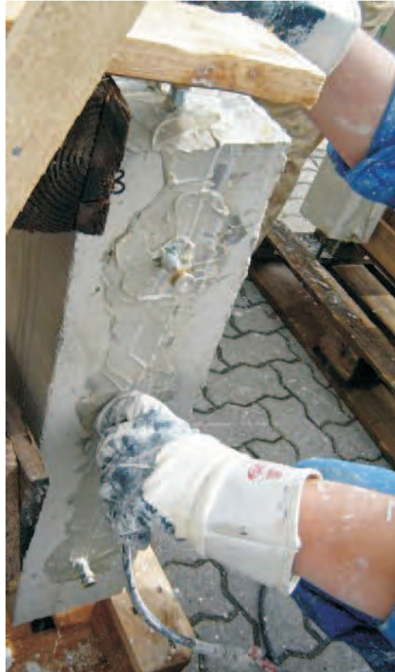
Abbildung 7.3: Verpressen der Versuchskörper mit Zementsuspension
