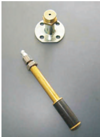
Abbildung 6.13: Klebepacker (oben) und Bohrpacker (unten)
