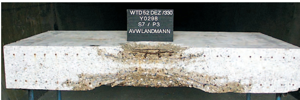
Abbildung 4.6: Feuchteverteilung in einem durchgeschnittenen Versuchskörper [148]
