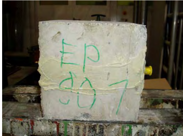
Abb. C.3.9: Instand gesetzte Würfel EP-45-4 (links) und EP-90-1 (rechts) nach einaxialem Druckversuch (klassisches Würfelversagen: Ausbildung einer „Sanduhr“)
