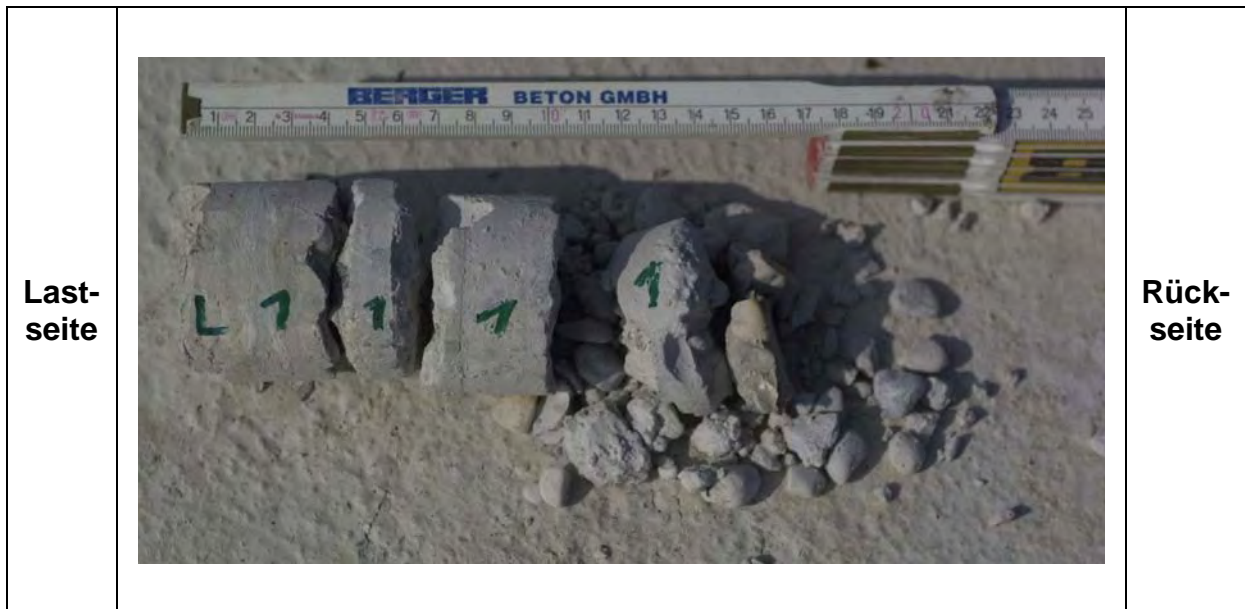
Abb. B.2.4: Entnommene Bohrkern Platte WTD 8 (Fortsetzung)
