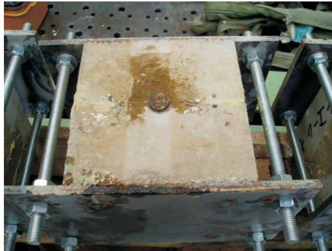
Abbildung 7.14: Instandsetzung mittels Tränkung
