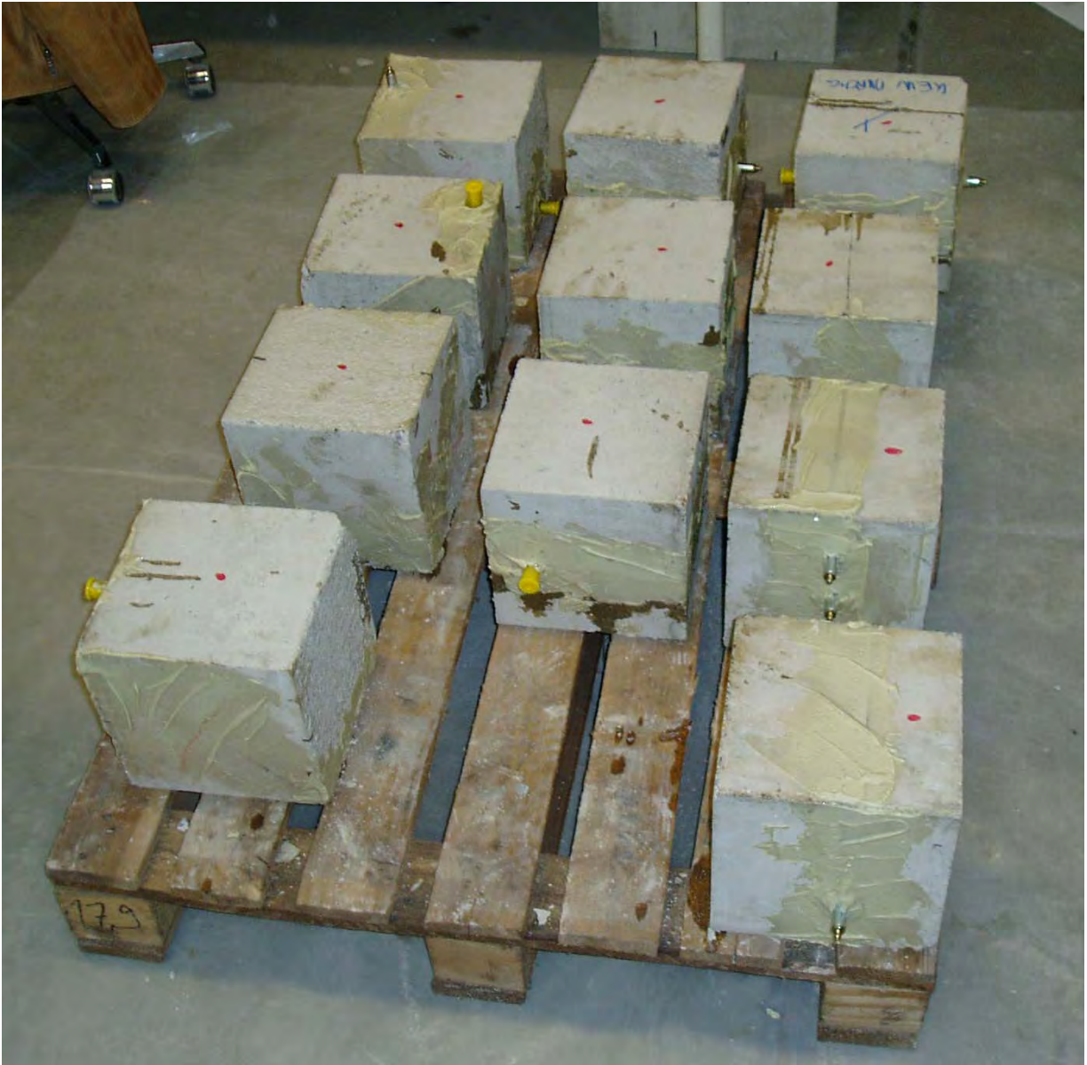
Abb. C.3.6: Instand gesetzte Probekörper vor einaxialem Druckversuch (alle)
