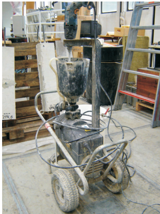
Abbildung 6.12: 1-K-Anlage für Niederdruckinjektionen
