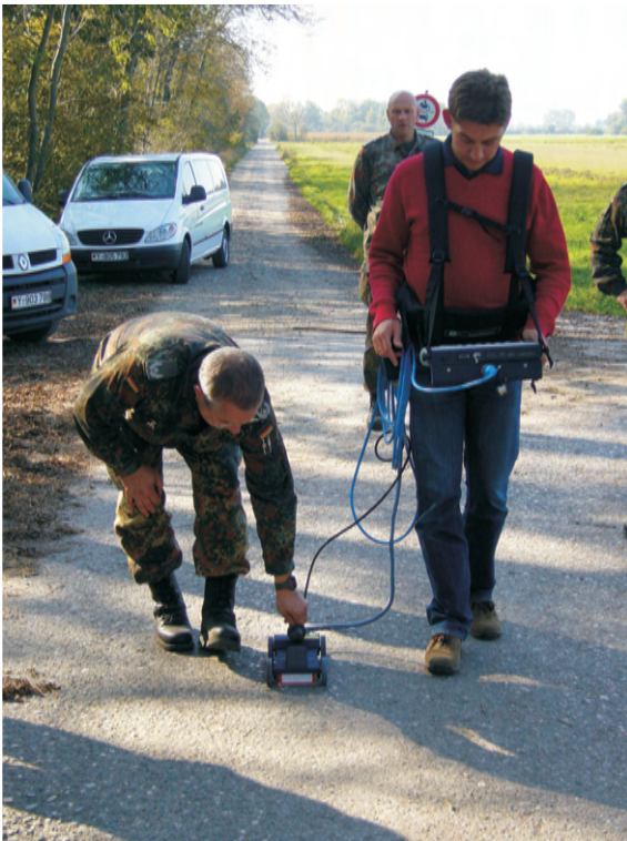
Abbildung 4.4: verwendetes kommerzielles Radar-System: portable Steuereinheit mit 1,6 GHz-Antenne im Feldeinsatz (links) und beispielhaft ermittelter Linienscan (rechts)
