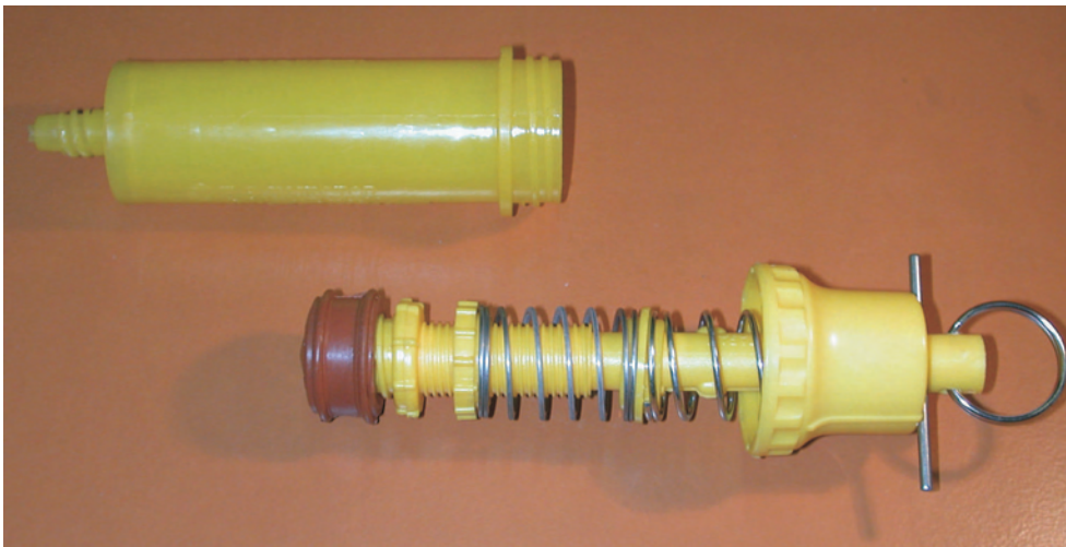
Abbildung 6.11: Selbstinjektor für Niederdruckinjektion
