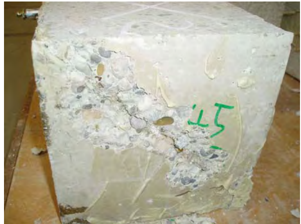
Abb. C.3.10: Instand gesetzter Würfel EP-45-3 nach einaxialem Druckversuch (Versagen: entlang der Verpressfuge)
