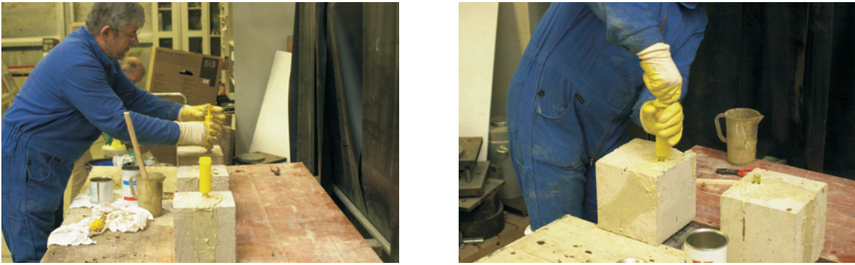
Abbildung 7.21: Injektion der gerissenen Würfel mittels Selbstinjektor (Niederdruckinjektion)
