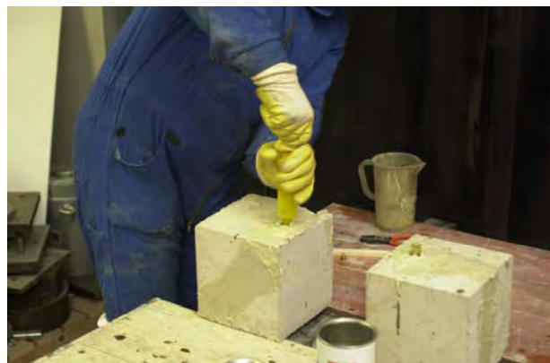
Abb. C.3.5: Instandsetzen der Probekörper durch Verpressen mit Epoxidharz mittels Niederdruckinjektion mit Selbstinjektor
