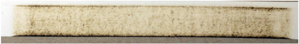
Abbildung 93 : Gleichmäßige Schwärzungsverteilung auf dem Klebeband als Nachweis der Homogenität des Plasmastrahls („Klebebandtest“), (20slpm Ar, 4 slpm N 2 , I=70A, U=203V, Abstand 8mm) .
