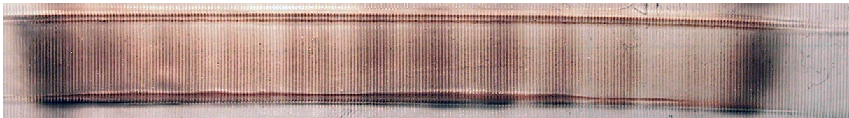
Abbildung 54 : Schwärzungsverteilung auf Klebeband („Klebebandtest“) zum Nachweis von Inhomogenitäten im Plasmastrahl, ( I=70A , 20 slpm Ar, 30 slpm N 2 ) .
