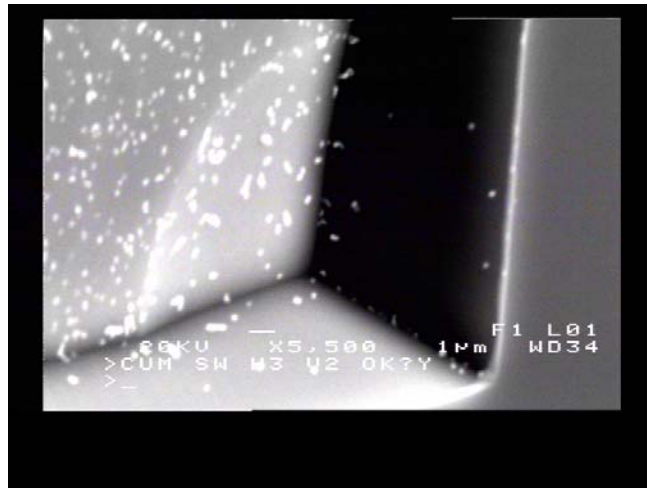
Abbildung 5.19 REM-Aufnahme (Rasterelektronenmikroskopie-Aufnahme) einer KOH geätzten Struktur. Es ist eine Ecke eines Kontaktgrabens gezeigt. Die Probe ist mit einem Winkel von 34^\circ verkippt. Man erkennt die Partikelkontamination im Ätzgraben, sowie die lokale Veränderung der Ätzrate im Bereich der Ecke. Es kann nicht mit Sicherheit festgestellt werden, ob es sich um eine Vertiefung oder Erhöhung des Grabenbodens im Bereich der Ecke handelt.
