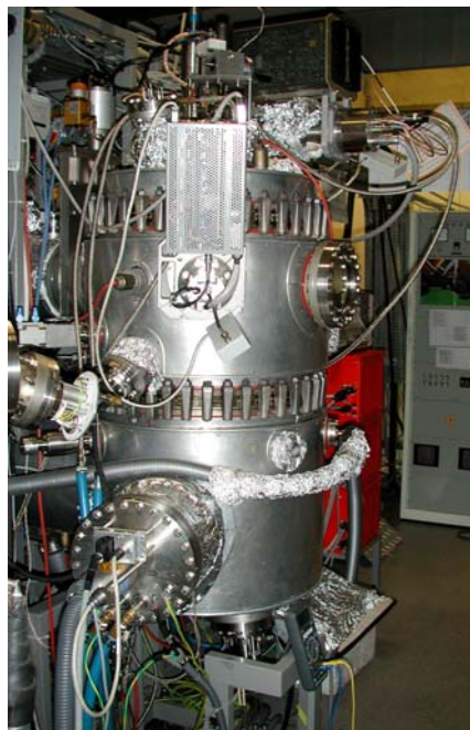
Abbildung 5.14 Epitaxiekammer P3 der Mehrkammer-Epitaxieanlage (MUM 545 Balzers) an der Universität der Bundeswehr München, Institut für Physik. Die Kammer ist mit zwei Elektronenstrahlverdampfern (ESV) und zwei Dotierstoffquellen ausgestattet.
