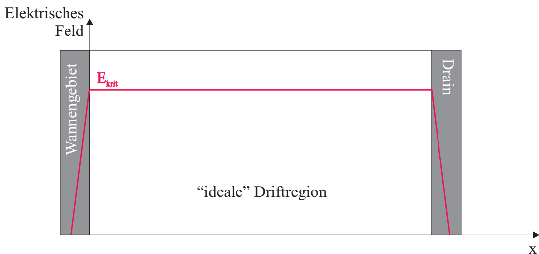
Abbildung 3.1 Schematische Darstellung des elektrischen Feldes in einer „idealen“ Driftzone. E_{krit} bezeichnet hier die maximale materialabhängige Durchbruchfeldstärke in intrinsischem Silizium.
