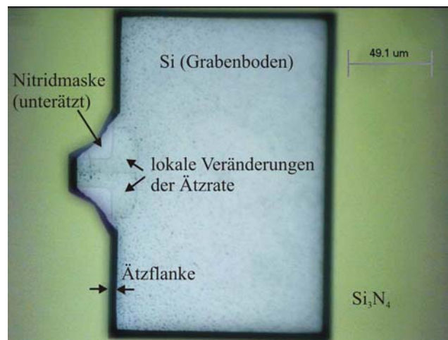
Abbildung 5.18 Optische Mikroskop-Aufnahme einer Hälfte einer „Fingerstruktur“. Diese Struktur wird in dieser Arbeit als Teststruktur für Dioden und Widerstände verwendet. In der Aufnahme ist ein Kontaktgraben von oben gezeigt. Die Ausstülpung nach links stellt den Kontakt zur Driftzone dar. Der Kontaktgraben wurde mit KOH geätzt.
