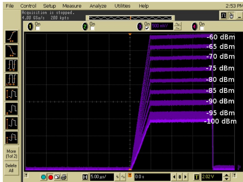
Abbildung 3.31: Oszillogramm; Darstellung der Integrationsergebnisse mit Streuung bei unterschiedlichem Eingangspegel
