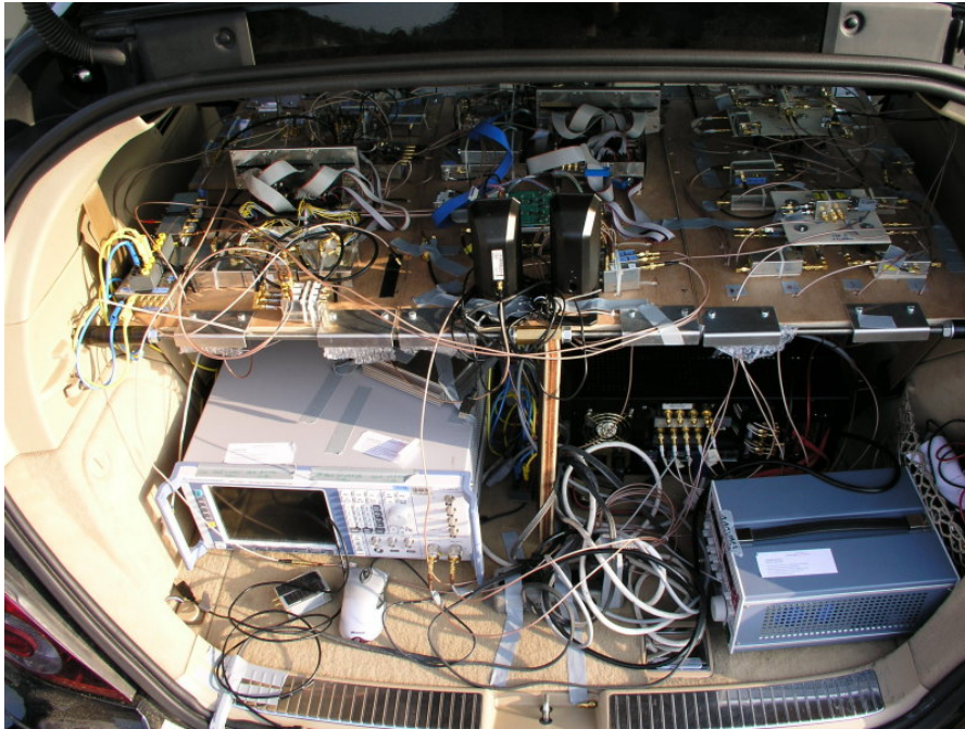
Abbildung 5.7: Messaufbauten im Kfz, rechts oben: Signalaufzeichnungseinheit, links/mittig: Diversitysysteme, rechts unten: Signalrekorder (schwarz), Detroit 2008
