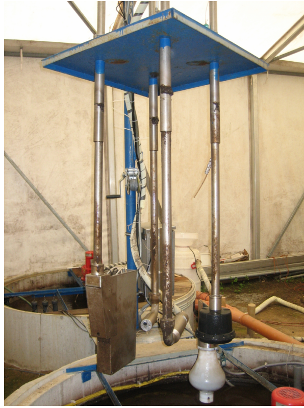
Abbildung 4.6: Sondenplattform mit Messeinrichtungen (von links nach rechts: FILTRAX -Modulträger, SOLITAX -Sensor, UVASC -Sonde und VOLITAX -Sonde)
