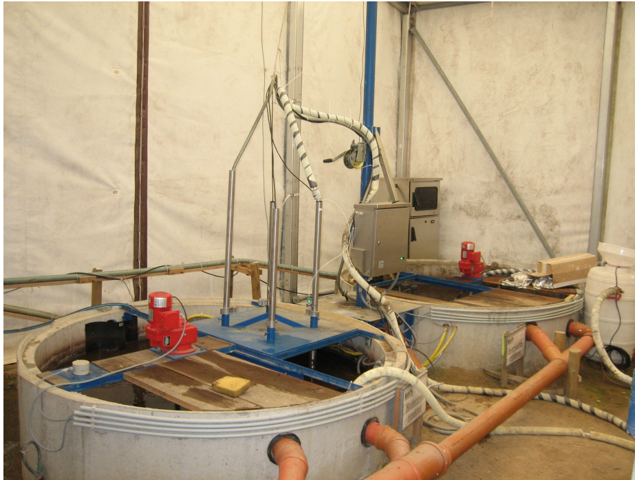
Abbildung 4.2: Fotografie der Versuchsanlage mit Sondenplattform (Bildmitte vorne), Probenehmer (Bildmitte hinten) und Kalkdosierung (rechter Bildrand)
