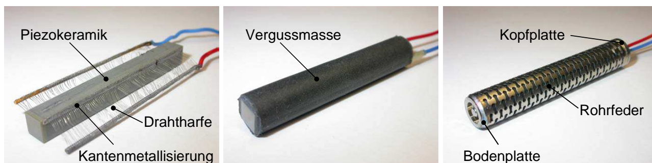
Abbildung 3.8: Übersicht des Aufbaus eines Piezostacks: Piezostack freigelegt (links), im vergossenen Zustand bzw. Auslieferungszustand (Mitte) und als fertig verschweißte PAU (rechts)
