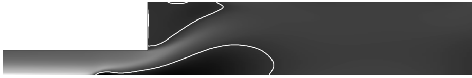
Abbildung 6.27: Konturplot der Axialgeschwindigkeit bei isothermer RANS, Rezirkulationszone markiert durch weiße Isolinie u_x = 0 .
