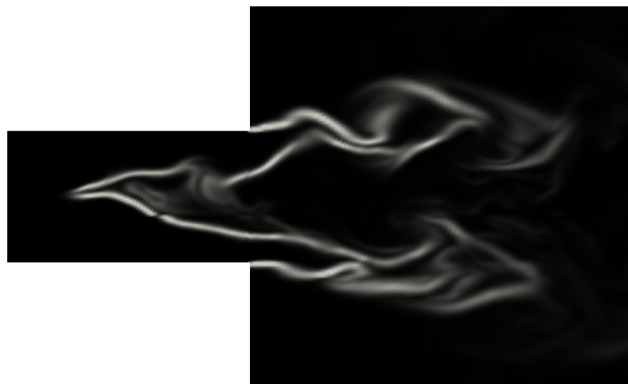
Abbildung 6.3: Reaktionsquellterm als Markierung der Reaktionszone, trotz stellenweiser Unterbrechung durch turbulente Wirbel liegen lokal zusammenhängende Reaktionszonen vor.
