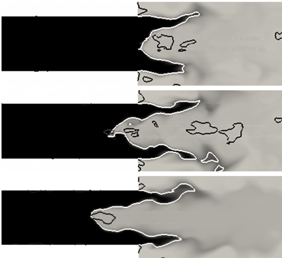
Abbildung 6.44: Kontur des Reaktionsfortschritts während des Flammenrückschlags mit LES. Oben kurz vor dem Einsetzen des Rückschlags, Mitte nach dem anfänglichen schnellen Rückschlag, unten während des langsamen Rückschlages (Weiße Isolinie c = 0.5 , Schwarze Isolinie u_x = 0 ).
