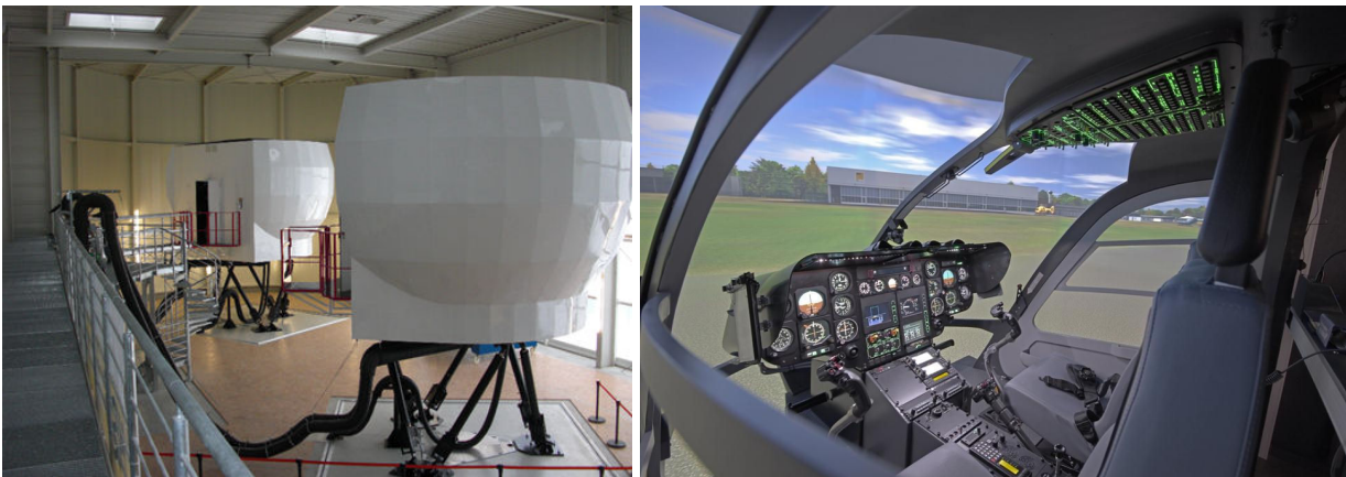
Abbildung 1.14: Flugsimulator der HEMS Adademy GmbH. Links: Außenansicht der Simulatoren, rechts: reales Hubschraubercockpit mit virtueller Projektion der Umgebung [54].
