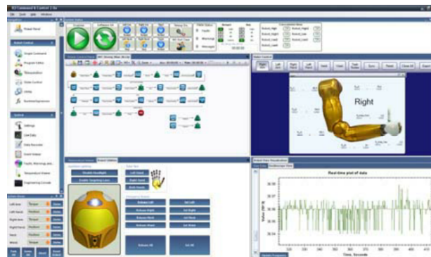
Abbildung 1.22: Die Operatorseite des Robonaut R2: Steuerung durch Schaltflächen oder Starten von vorbereiteten Programmabläufen [34].
