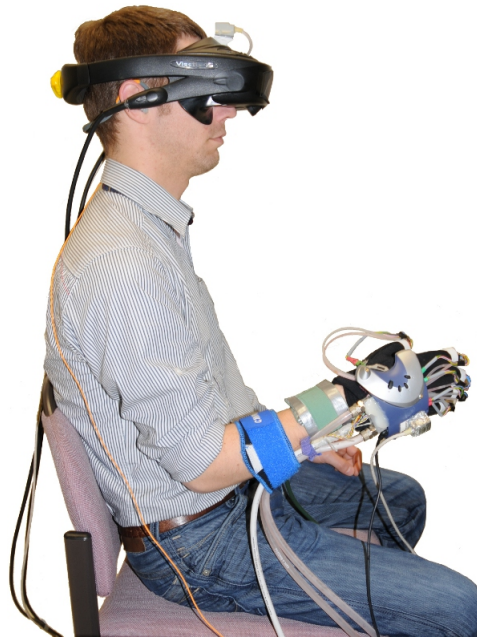
Abbildung 2.2: Operator der virtuellen Umgebung mit Head Mounted Display und Datenhandschuh [51].
