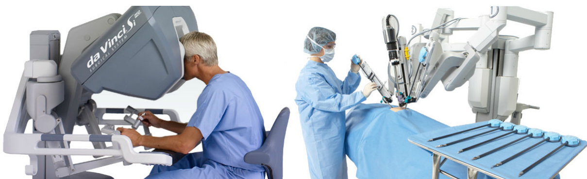
Abbildung 1.23: Das da Vinci Si System der Firma Intuitive Surgical, Inc. Links: Operatorschnittstelle mit behandelndem Arzt, rechts: Teleoperator mit Patient, OP Personal und verschiedenen Manipulatoraufsätzen [63].
