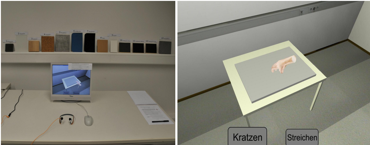
Abbildung 3.16: Aufbau der Experimentalumgebung. Links: Probandenplatz mit Stimulipool, Bildschirm, Kopfhörer und Maus. Rechts: Blick auf die virtuelle Testplatte und Schaltflächen für Kratzen/ Streichen [51].
