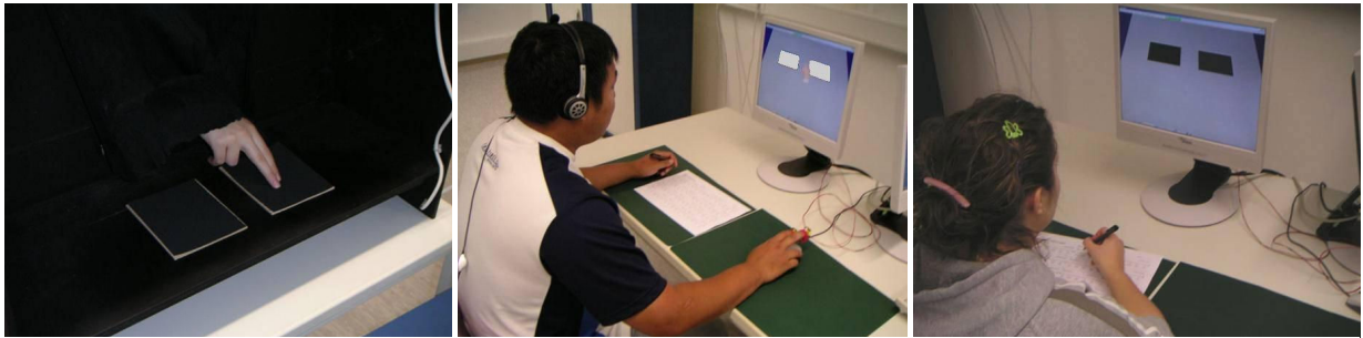
Abbildung 3.2: Drei Diskriminationsaufgaben (v.l.n.r.): REAL: reales haptisches Feedback, VR_{vib} : vibrotaktiler Feedback, VR_{vis} : visuelles Feedback [51].
