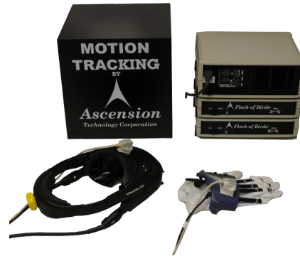
Abbildung 2.4: Flock of Birds Trackingsystem, v.l.n.r.: Extended Range Transmitter, 3 FoB Control Boxes, ein Flock of Birds Sensor auf Head-Mounted-Display, einer auf P5-Datenhandschuh [51].
