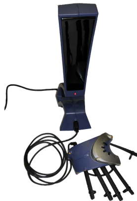
Abbildung 2.3: Original P5 Datenhandschuh mit Sensortower [51].
