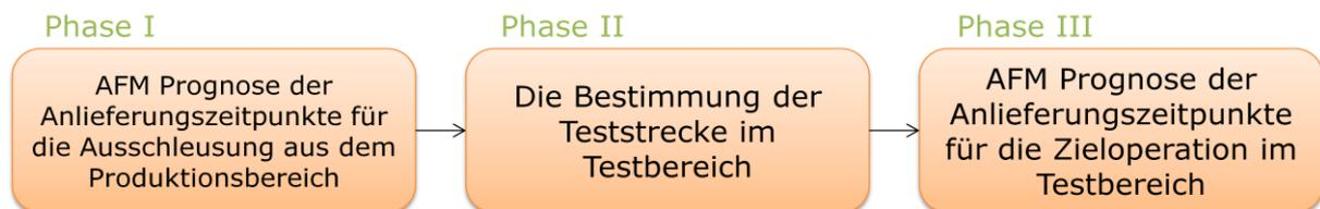
**Abbildung 4-31: Das Phasenmodell für die Voraussage der Anlieferungszeitpunkte in dem Testbereich der Fertigung**
