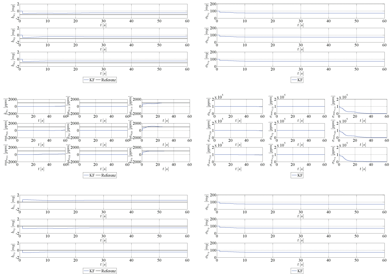
Abbildung 55: Beschleunigungsfehlerparameter bei Höhenänderung
