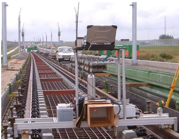
Abb. 2.12: Bestimmung der Gleisparameter über eine Langsehne (iGW, intermetric) [intermetric 2015]
