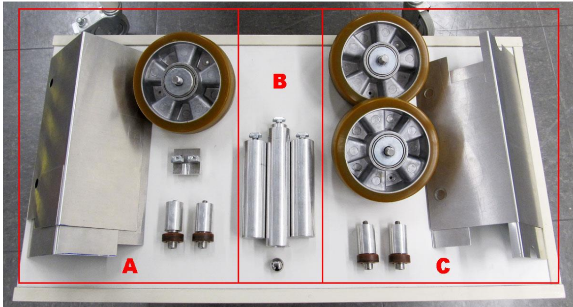
Abb. 6.9: Notwendige Modifikationen für die Kalibrierung von Lasertriangulationssensoren
