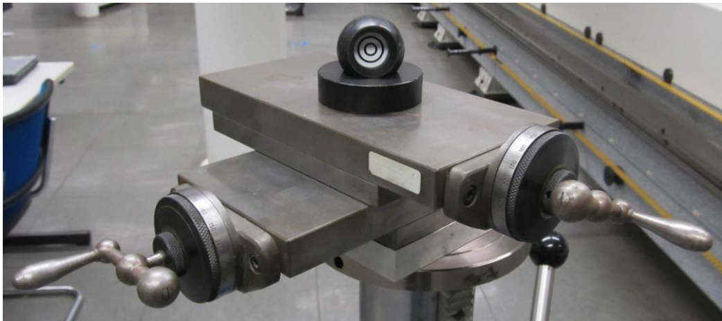
Abb. 6.5: Modifiziertes Corner-Cube-Prisma auf Kreuzschlitten
