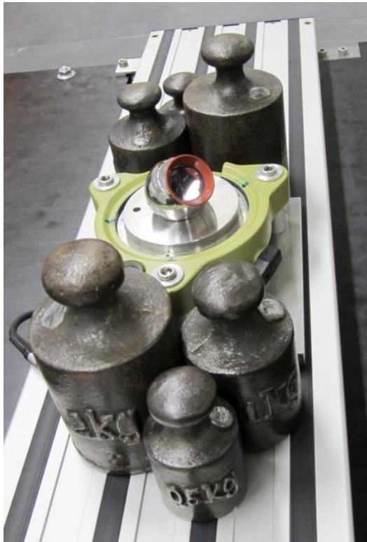
Abb. 6.10: Ersatzgewichte für das Tachymeter und CCR-Adapterscheibe mit aufgesetztem CCR
