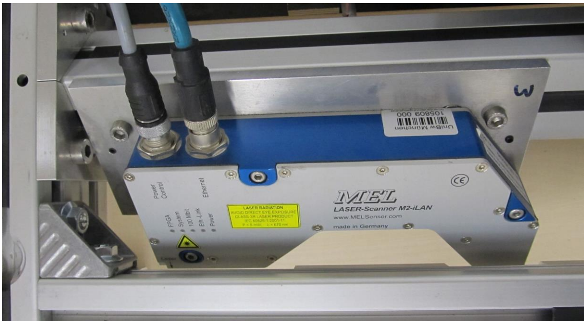
Abb. 3.7: Lasertriangulationssensor MEL M2-ILAN 120/60 innerhalb der MSP des RACER II
