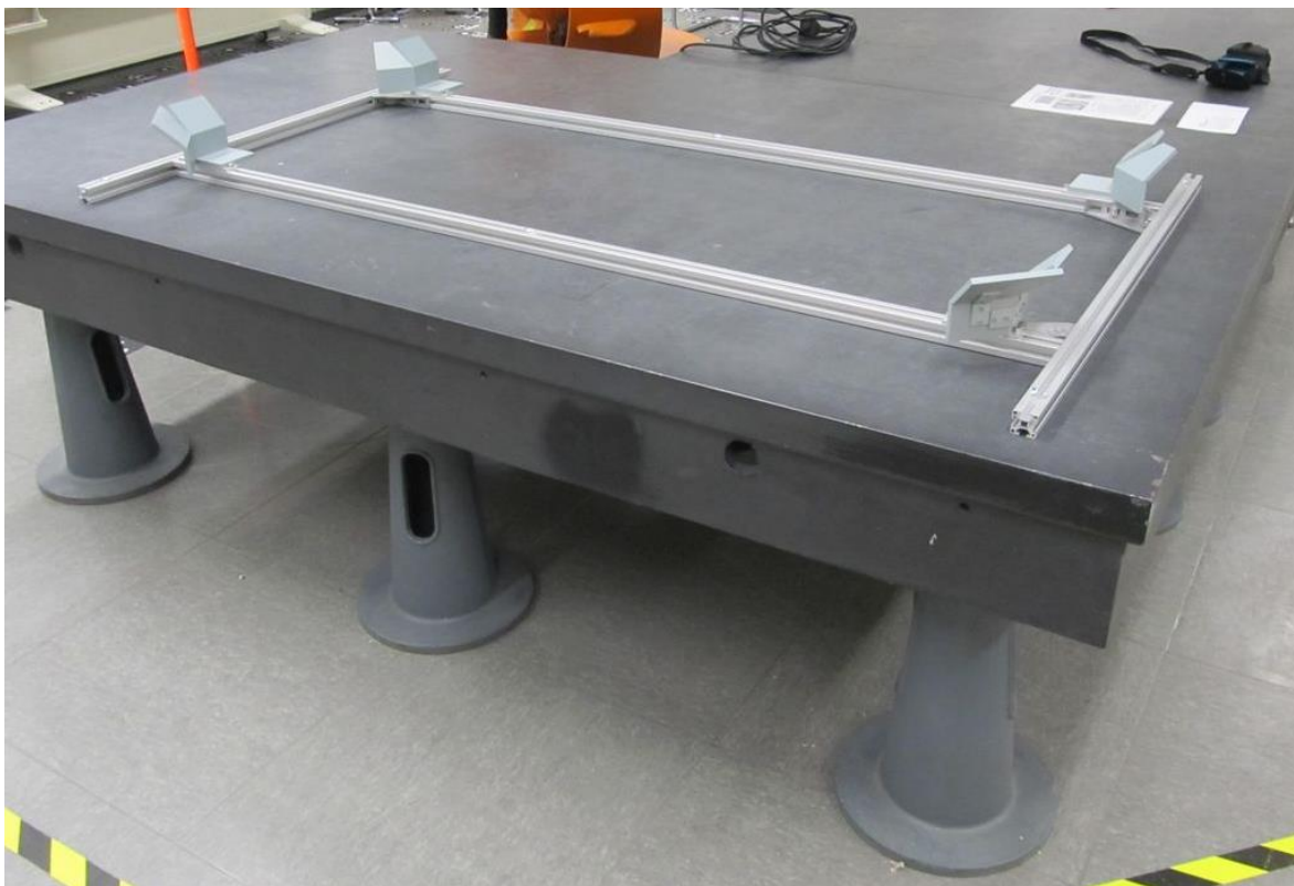
Abb. 6.6: Kalibriervorrichtung des RACER II auf stabilem Metalltisch
