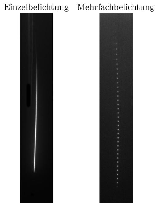
**Abbildung 5.4:** Partikeltrajektorien bei Aufnahmen mit Einzel- und Mehrfachbelichtung
