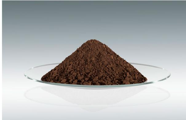
**Abbildung 2.5:** Handelsübliches Borpulver der Fa. H.C. Starck [HC 15]
