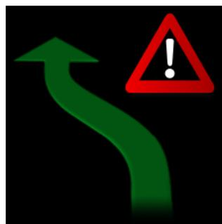
**Abbildung 35: Anzeige "Ausweichpfeil" (schwarze Bildanteile entfallen im HUD)**
