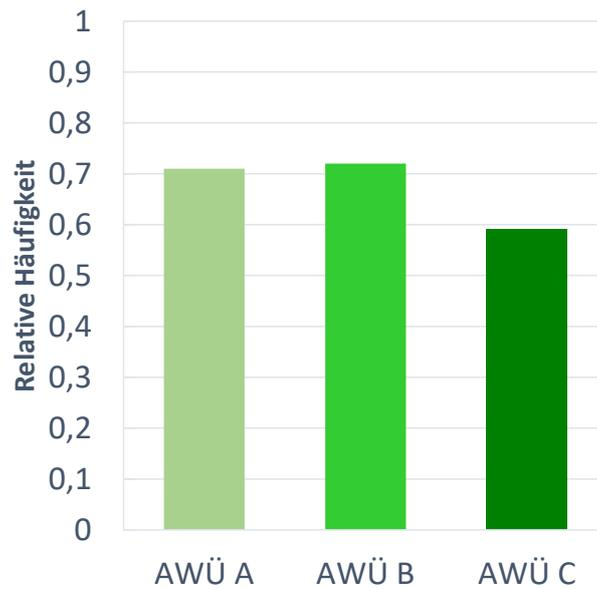
Abbildung 23: Relative Häufigkeit vermiedener Kollisionen beim Ausweichen mit Ausweichunterstützung (AWÜ) für Hilfsmomentverlauf A („Rechteck“), B („Trapez“) und C („Dreieck“)
