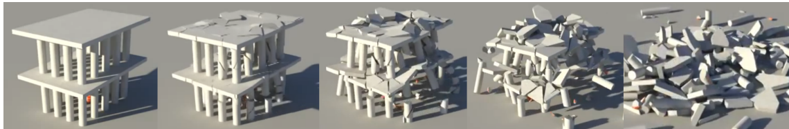
Abbildung 3.5: Zeitreihe der Erzeugung eines Gebäudeschadens per Voronoi Fracturing aus [98] (URL: http://www.youtube.com/watch?v=pGn3kNCPpHk letzter Zugriff: 12.05.2018).
