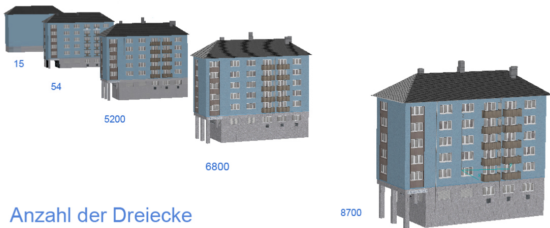
Abbildung 2.11: Geometrische Level of Detail zur Simplifizierung auf Basis der Anzahl der Dreiecke aus [95].
