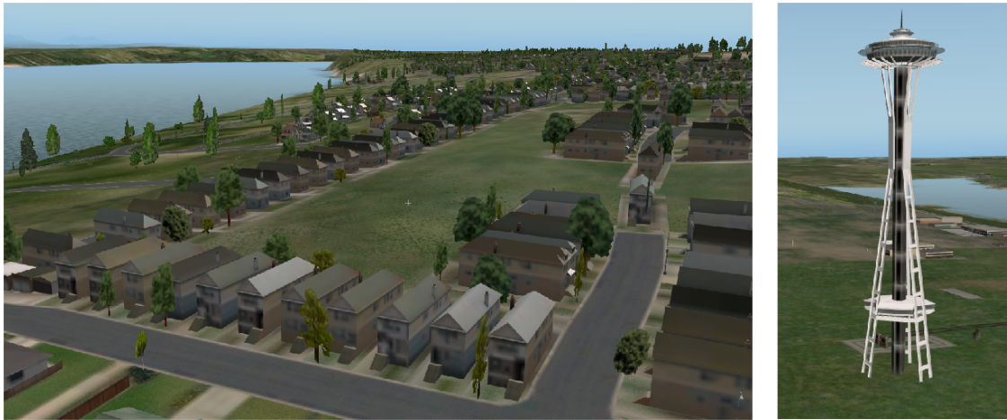
Abbildung 2.12: Darstellung von geotypischen (links) und geospezifischen 3D-Gebäudemodellen (rechts) aus der Flugsimulationssoftware X-Plane [97].
