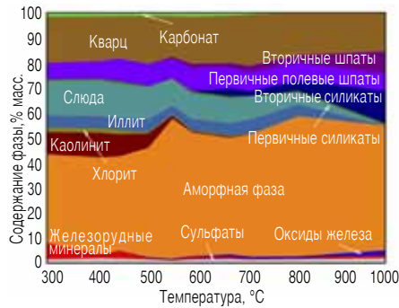
Рис. 3. Изменение минерального состава в зависимости от температуры тепловой обработки глины смешанного типа [12]
